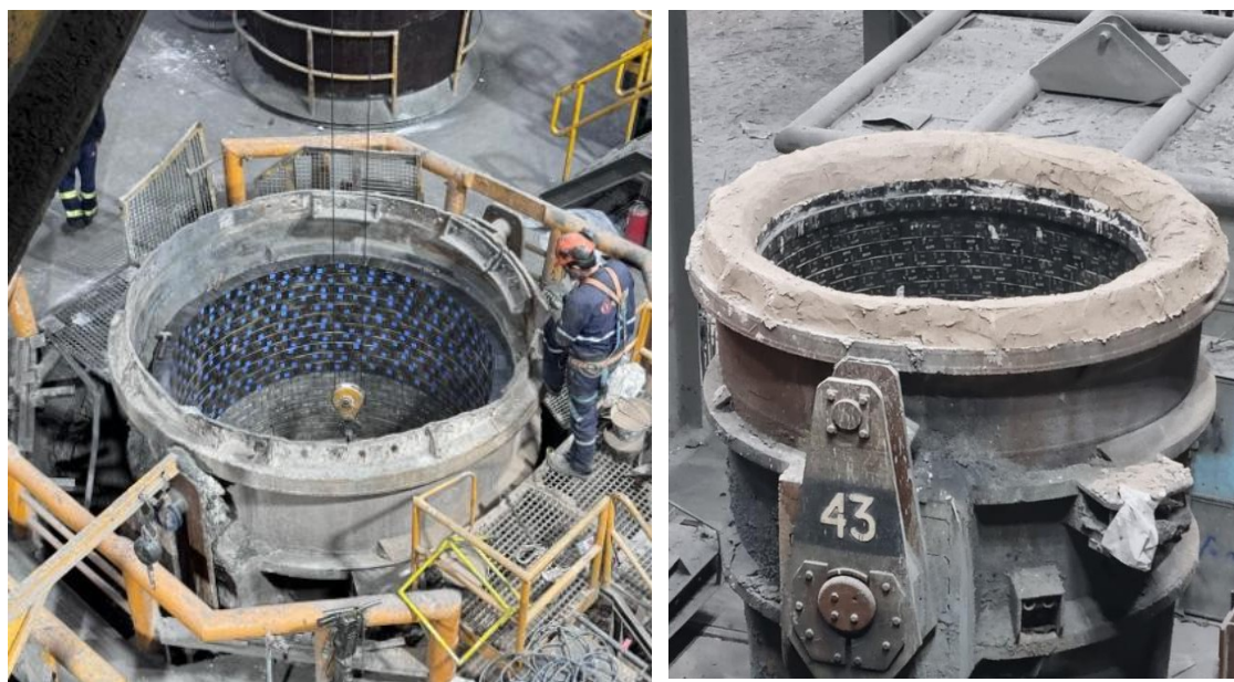
Figura 16. Etapa final de colocación de ladrillos refractarios nuevos en la cuchara (izquierda) y cuchara con revestimiento refractario nuevo (derecha).
