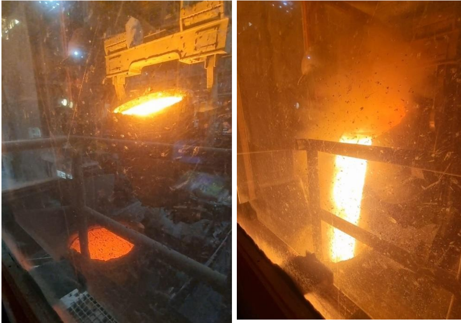
Figura 7. Cuchara inclinada para el trasvase (izquierda) y proceso de trasvase (derecha).
