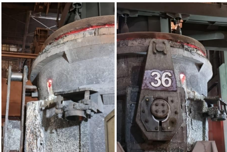
Figura 9. Vistas de una cuchara con filtración de acero por caída de ladrillo.
