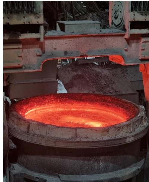
Figura 32. Cucharas con alto nivel de acero: rebalse (izquierda) y zona acero/escoria en contacto con los ladrillos de cierre (derecha).
