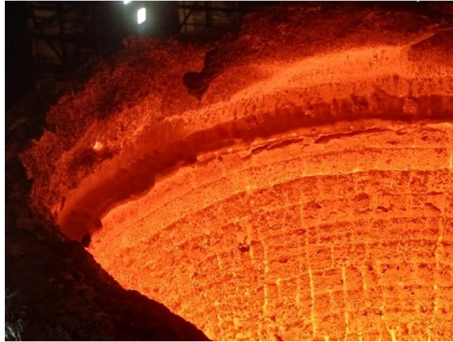
Figura 10. Ladrillos de línea de escoria con desgaste excesivo.
