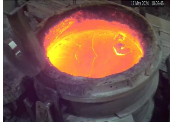
Figura 31. Cucharas con nivel de acero adecuado.
