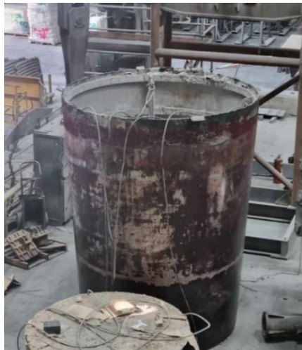
Figura 13. Molde para realizar el colado del revestimiento refractario de seguridad de la pared de la cuchara.
