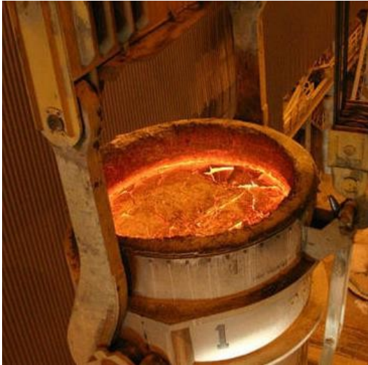
Figura 31. Cucharas con nivel de acero adecuado.
