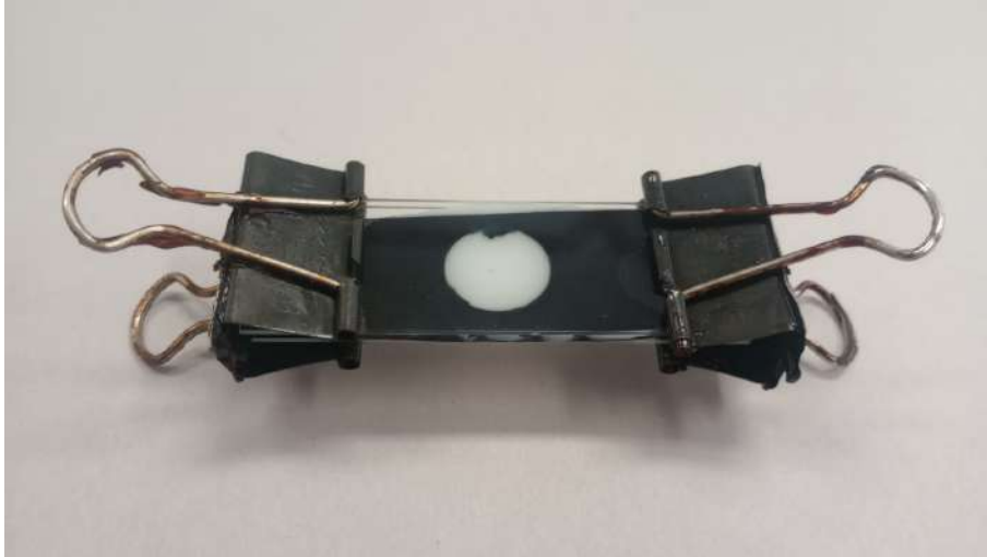
Figura 2.10: Muestra para termo-curado de resina modificada con PBO.
