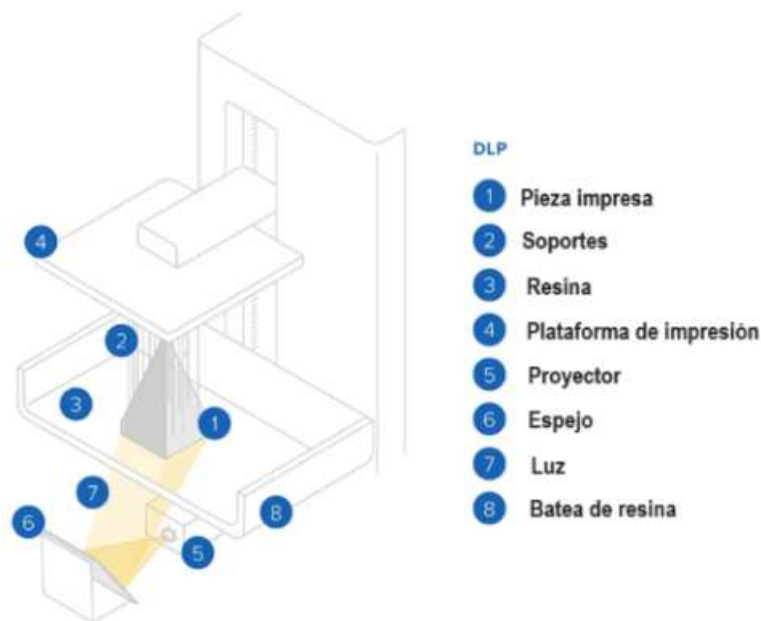
Figura 1.5: Esquema de impresora DLP bottom-up .
