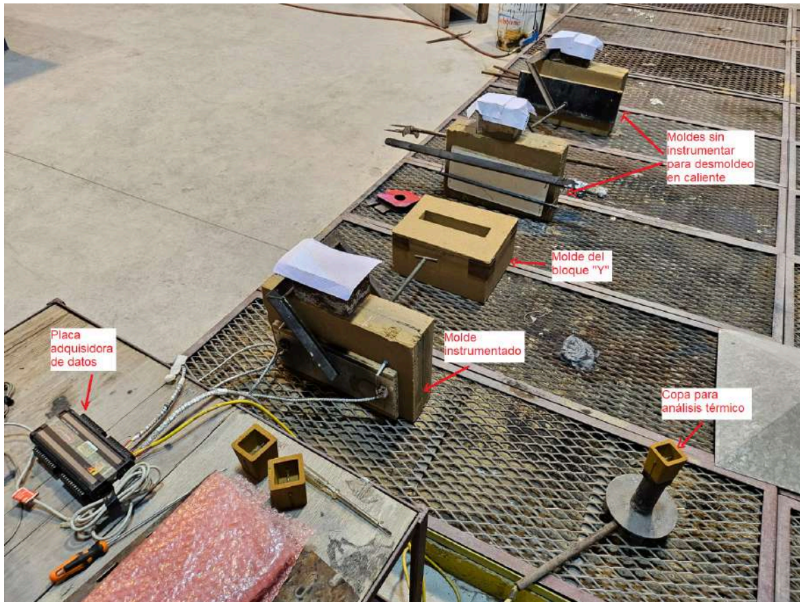
Figura 4.3: Disposición de moldes para colar y placa adquisidora de datos
