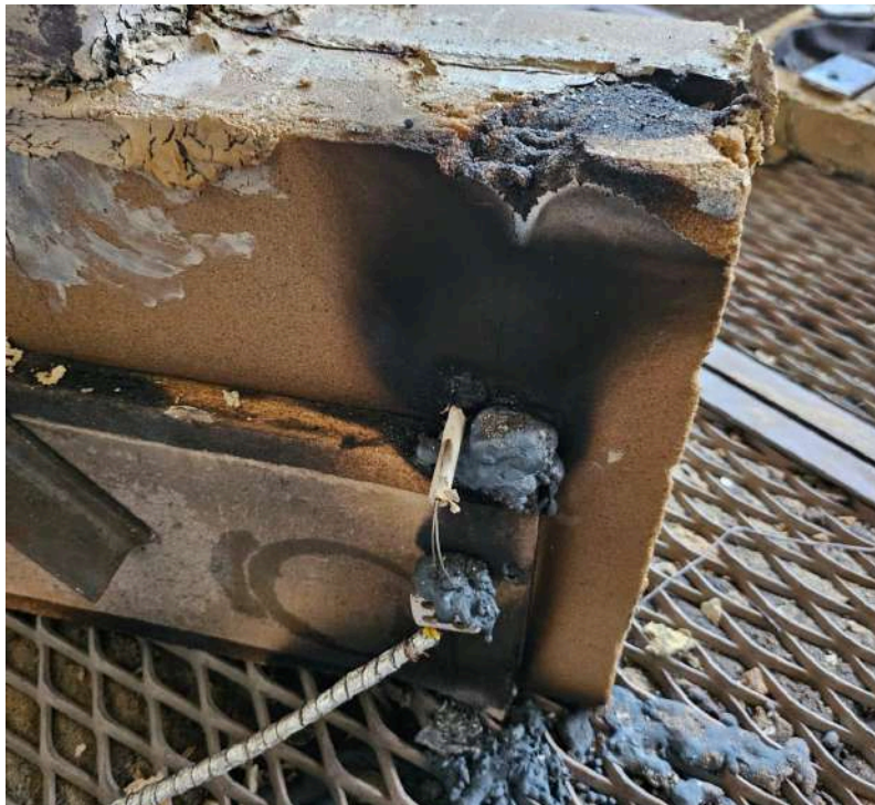
Figura 4.8: Molde con desborde de metal líquido
