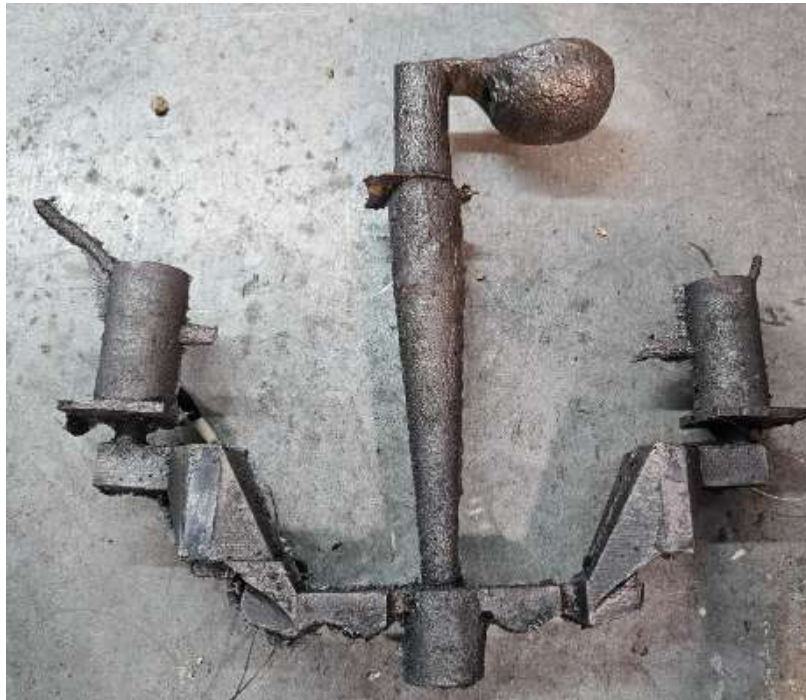
Figura 4.10: Sistema obtenido del molde instrumentado
