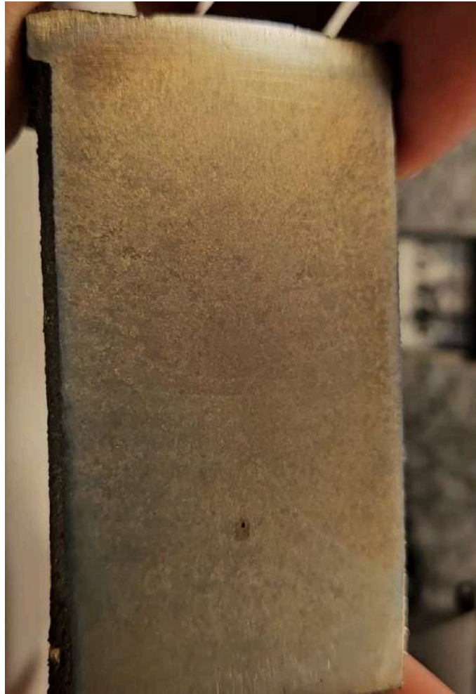
Figura 4.16: Macroestructura de la Pieza 4 luego del ataque con Nital 2%
