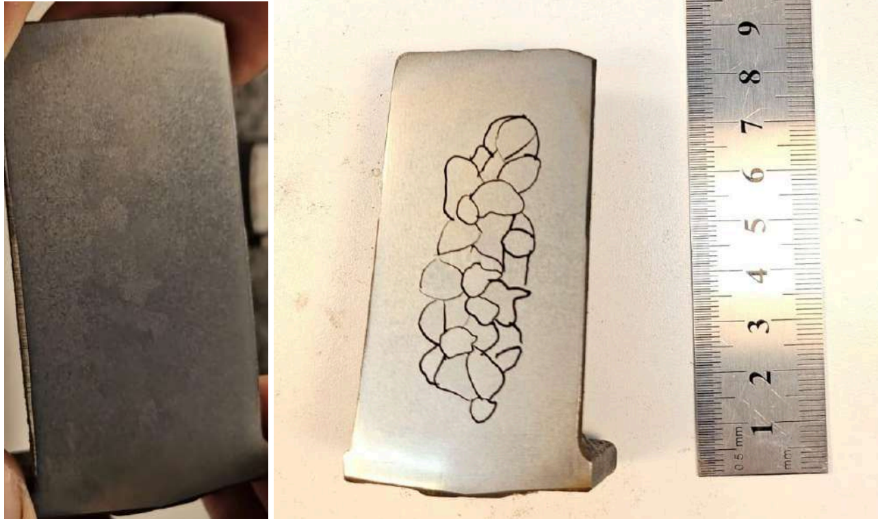
Figura 4.24: Forma y distribución de los granos de la pieza 6*. A la izquierda la pieza sin contornear y a la derecha la pieza contorneada.
