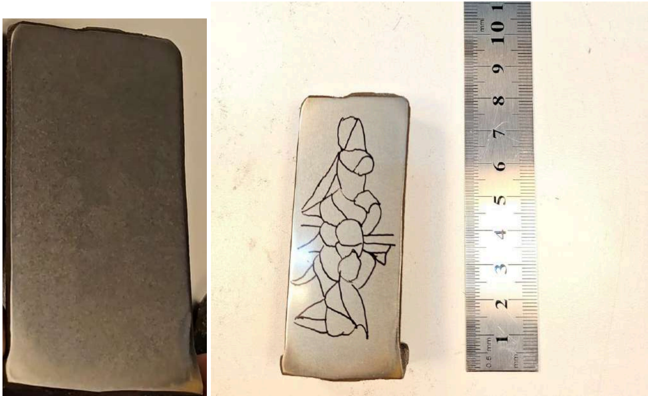
Figura 4.22: Forma y distribución de los granos de la pieza 2. A la izquierda la pieza sin contornear y a la derecha la pieza contorneada.
