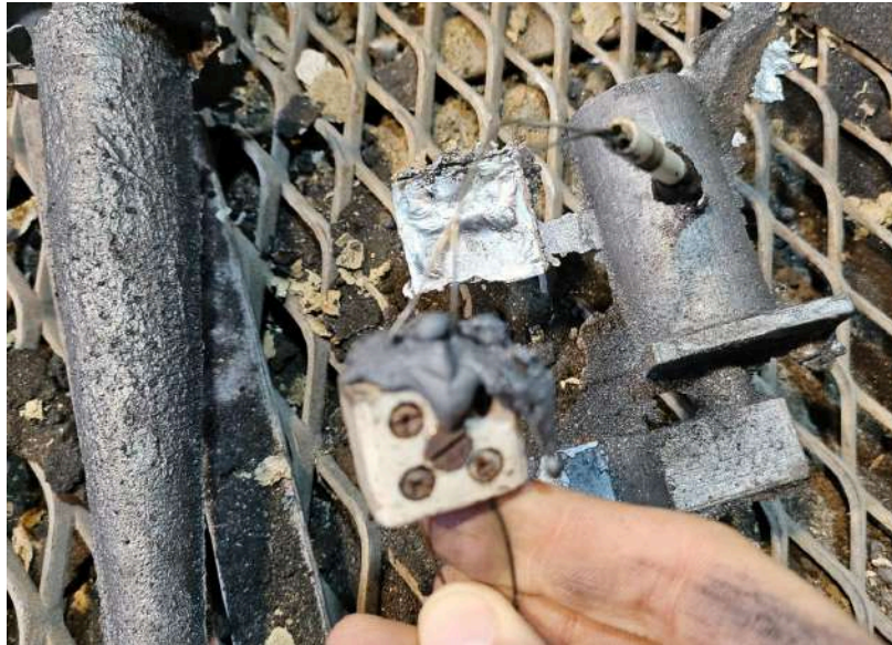
Figura 4.7: Conector de la termocupla con metal fundido
