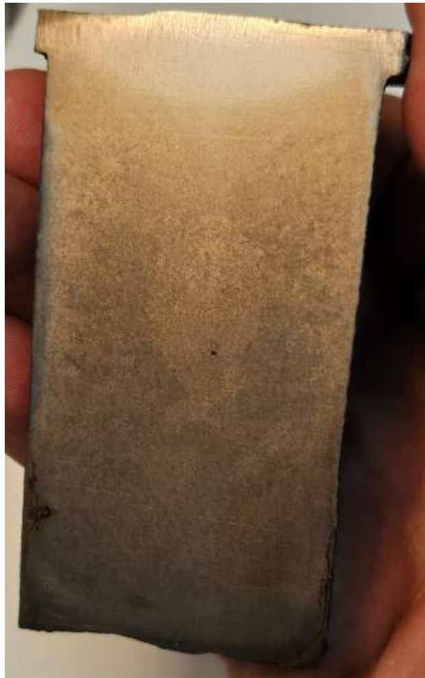
Figura 4.17: Macroestructura de la Pieza 6 luego del ataque con Nital 2%
