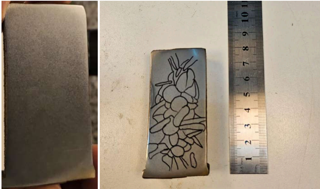
Figura 4.21: Forma y distribución de los granos de la pieza 0. A la izquierda la pieza sin contornear y a la derecha la pieza contorneada.
