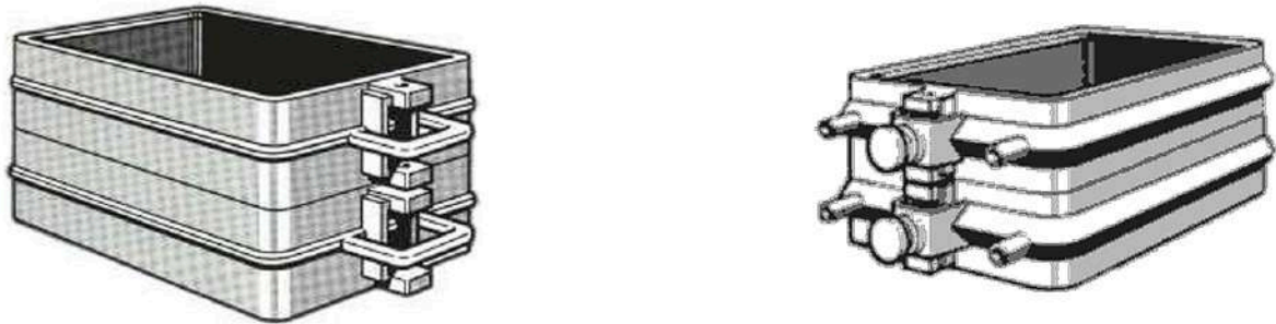
Figura 1.7: Distintos tipos de cajas de moldeo
