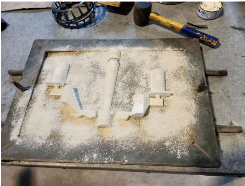
Figura 3.3: Primera mitad del molde seco con talco industrial
