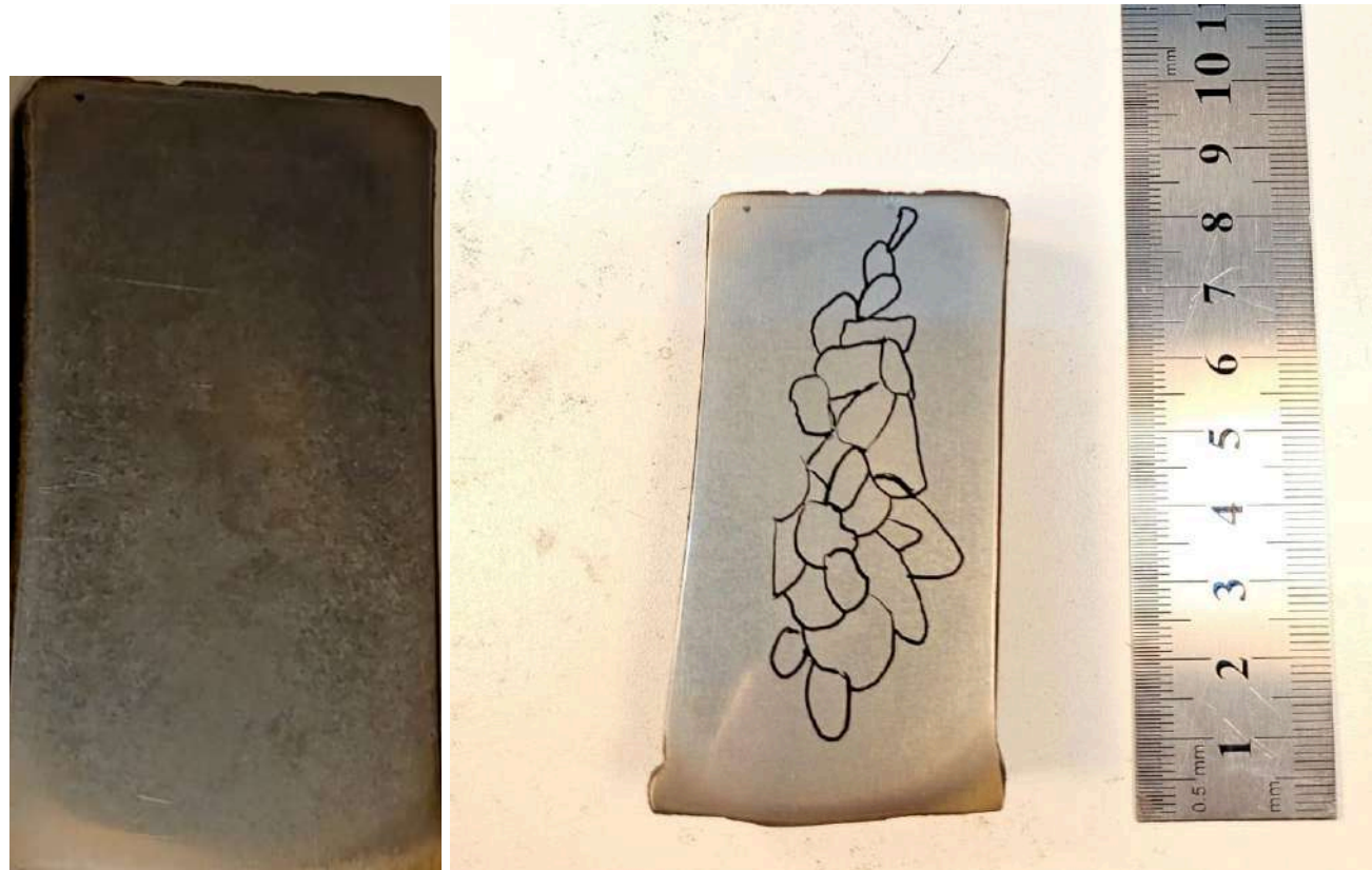
Figura 4.23: Forma y distribución de los granos de la pieza 4*. A la izquierda la pieza sin contornear y a la derecha la pieza contorneada.
