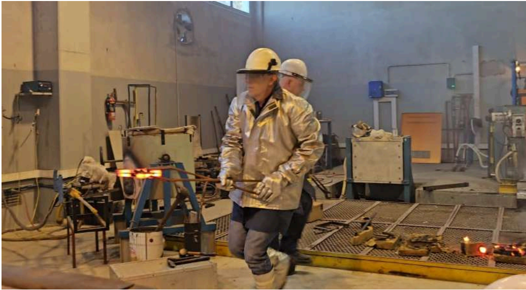
Figura 4.6: Transporte de pieza desmoldeada en caliente hacia la mufla
