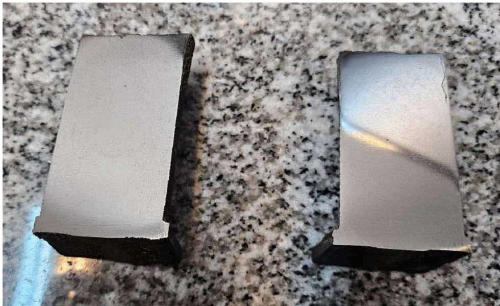
Figura 4.12: Pieza "4" (izquierda) y "6" (derecha) después del rectificado, desbaste y pulido metalográfico.
