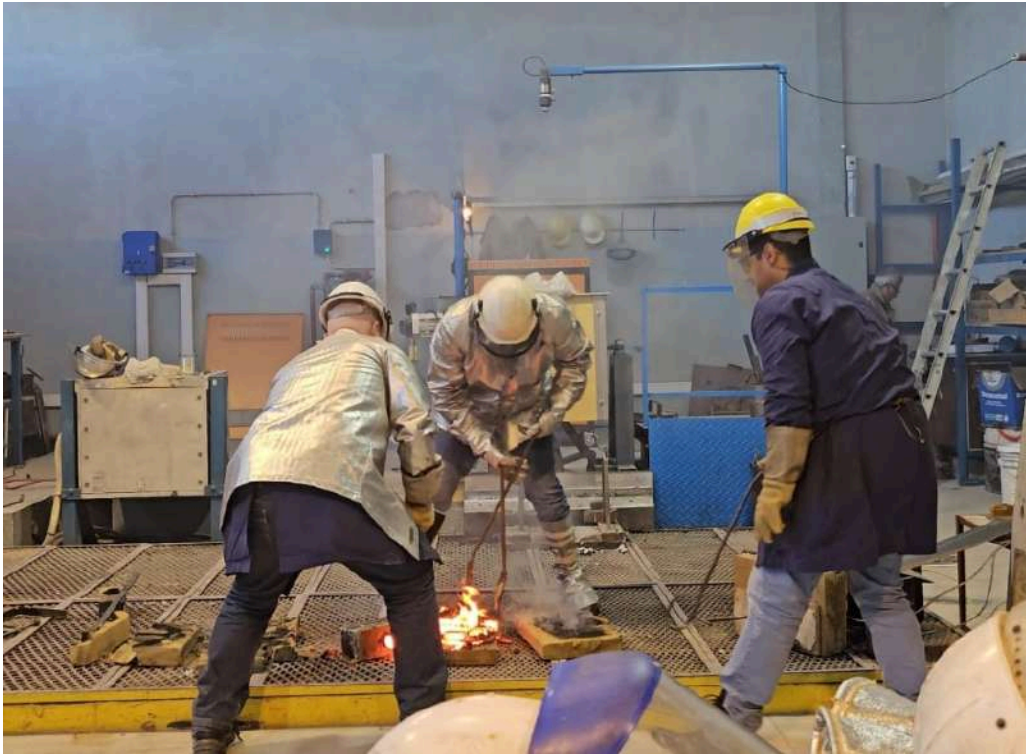
Figura 4.5: Desmoldeo en caliente
