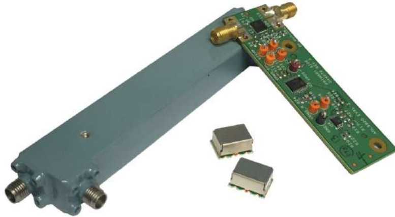
Figura 6: Comparación en tamaño entre un acoplador convencional, el kit de evaluación del ADL5920 (VWRS-meter) y el chip integrado ADL5920. Fuente: [5].
