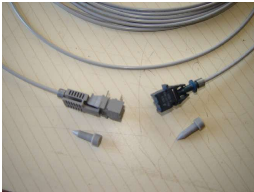
Foto del emisor y receptor colocados en la fibra óptica
