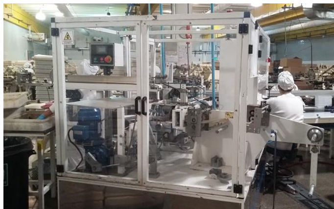
Figura 14. Ejemplo de aplicación de cabina acústica de atenuación del ruido en máquina envasadora
