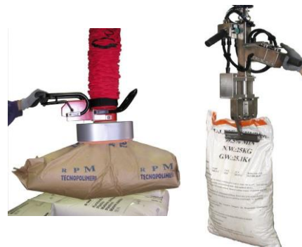
Figura 6. Ejemplo de brazo neumático para transporte de carga para pouch
