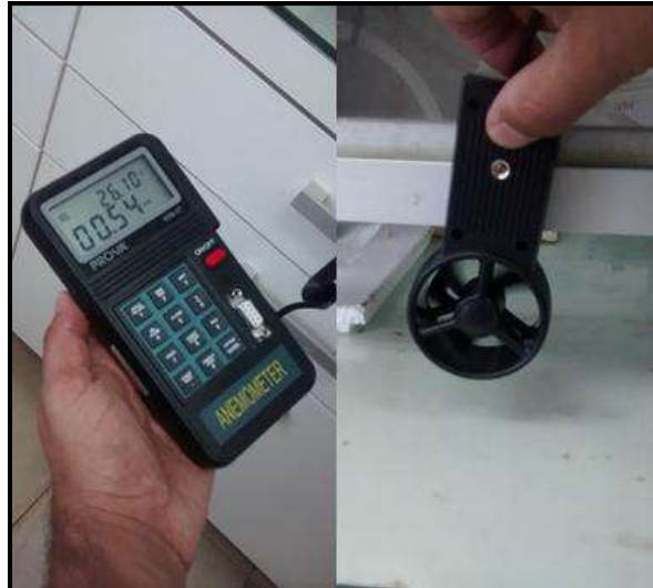
Figura III: Medición de la velocidad de captación en el frente de la cabina mediante un termoanemómetro PROVA AVM 07. Fuente: Elaboración propia.
