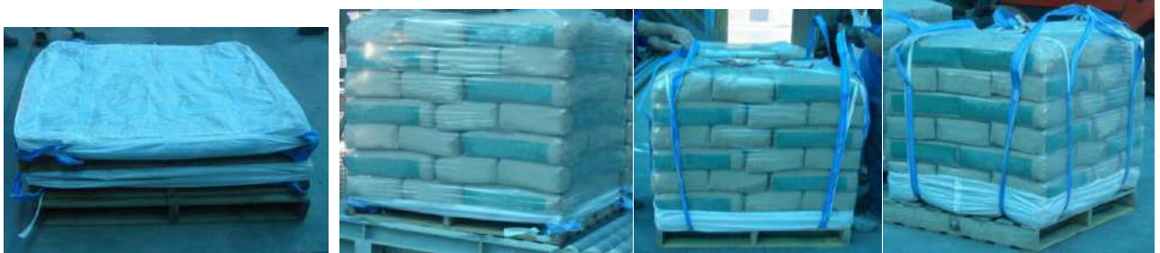
Figura 25- Colocación de eslingas en la paletización (F2 Servid, 2012)
