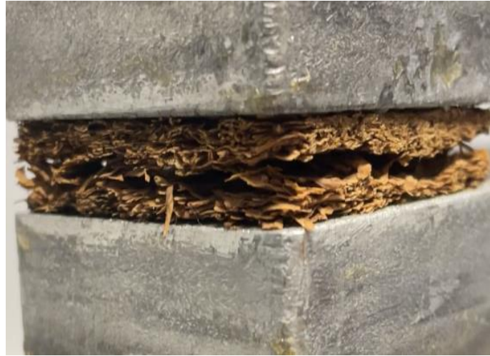
Fig.3.9 Perfil de rotura ensayo IB
