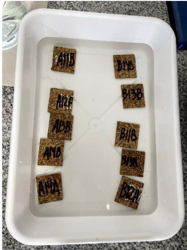
Fig.2.6 Ensayo de hinchamiento y absorción de agua para probetas CA y BSG
