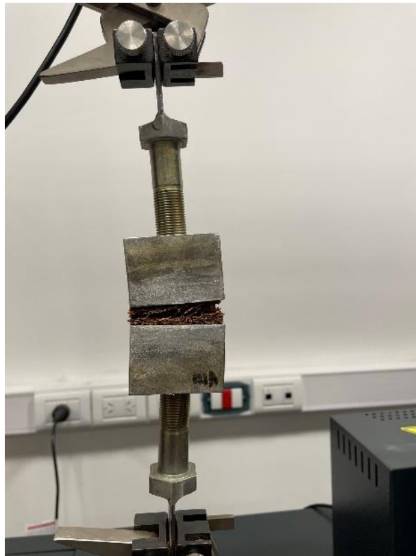
Fig.2.5 Ensayo de adhesión interna para probetas de CA y BSG
