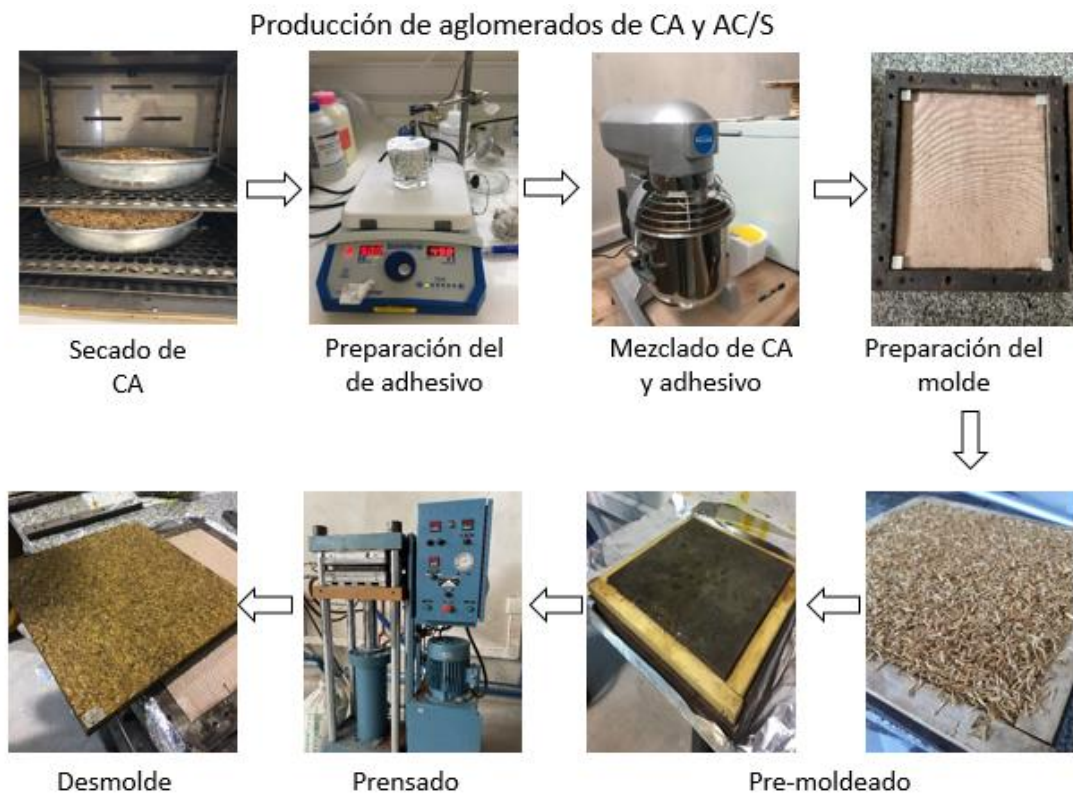
Fig.2.1 Producción del aglomerado basado en cascara de arroz y adhesivo cítrico-sacarosa
