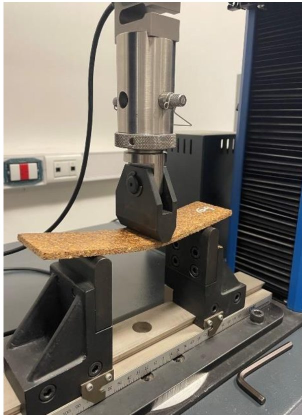
Fig.2.4 Ensayo de flexión en tres puntos para probetas CA y BSG
