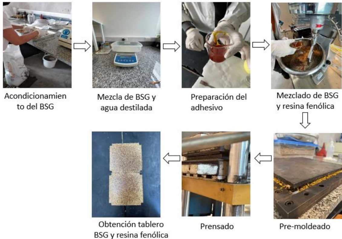
Fig.2.3 Producción de aglomerados de BSG con resina fenólica
