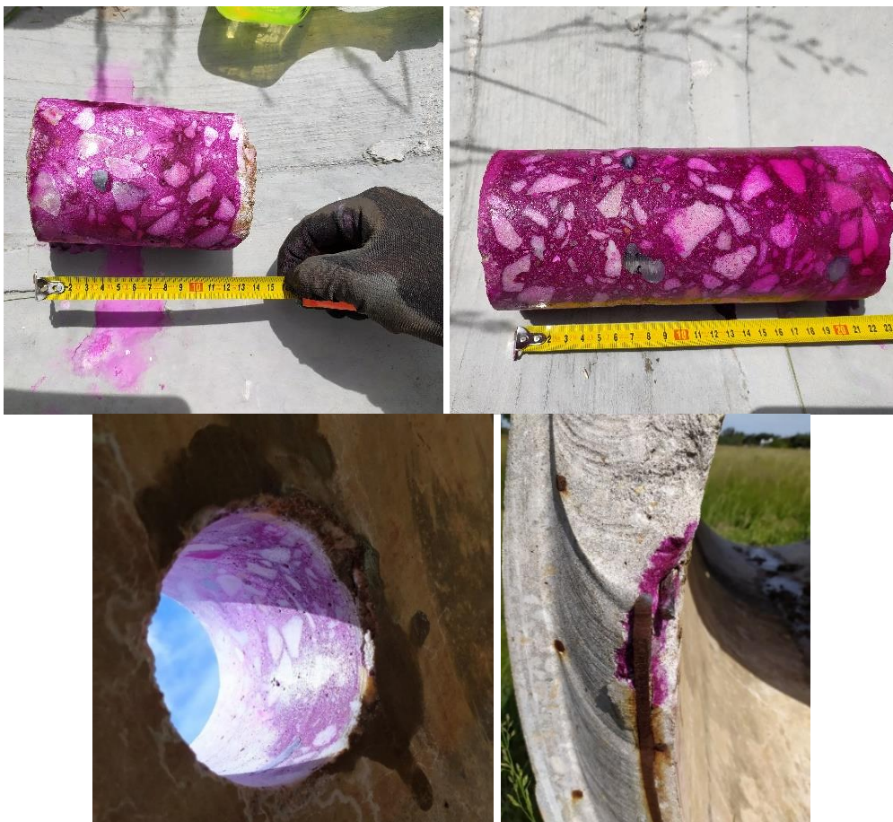
Figura 19. Superficies expuestas durante la extracción de testigos.
