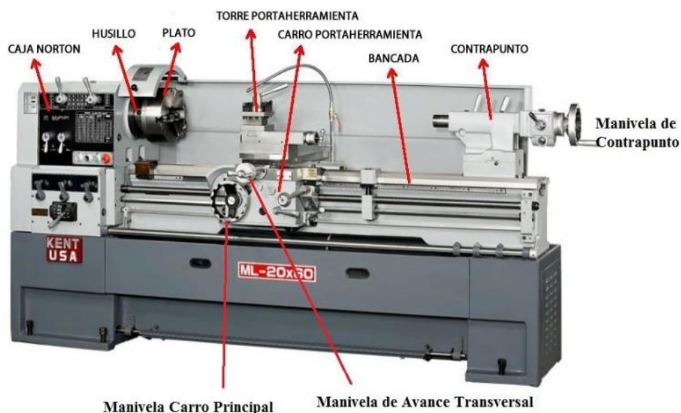
ILUSTRACIÓN 9 - TORNO PARALELO
