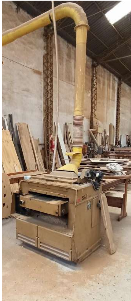
Figura 3.2.3.6 A2C/2: Cepilladora de 0,37kW de potencia marca L'Invincible.
