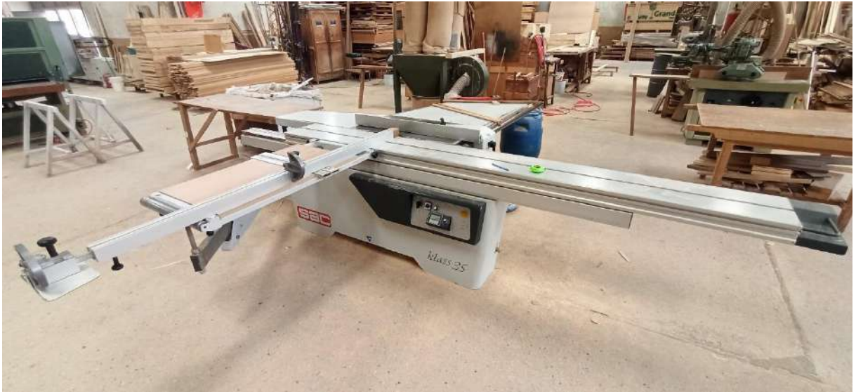
Figura 3.2.3.7 A2E: Escuadradora SAC Klass 35 de 4,75kW de potencia marca Höchsmann.
