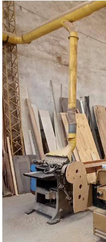
Figura 3.2.3.5 A2C/1: Cepilladora de 0,22kW de potencia.
