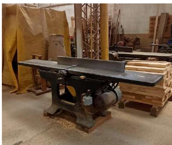
Figura 3.2.3.3 A1G/1: Garlopa de 4kW de potencia marca Maschinen-Werke Gubisch.
