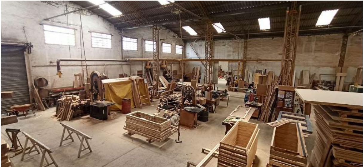
Figura 3.1.2.1 Nave principal desde el sector de depósito de materia prima, a la izquierda el sector de etapa inicial, a la derecha materia prima apilada y las mesas de mecanizado a mano. Al fondo la entrada a la nave de melamina junto a los dos tupíes.
