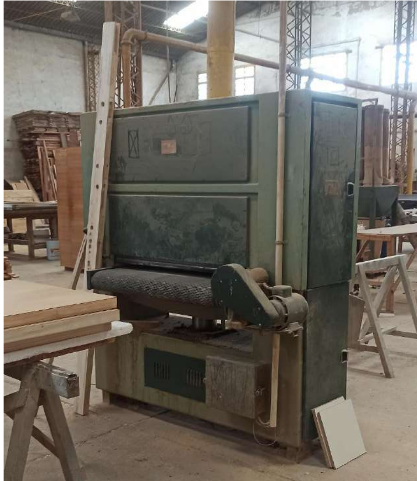
Figura 3.2.3.17 B2C: Lijadora de contacto de 5,3kW de potencia marca Farven.
