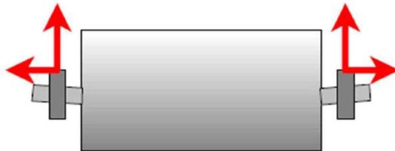
Figura 3.3.2.8 Eje flexionado. Fuerzas axiales y radiales o tangenciales según la flexión del eje. [12]
