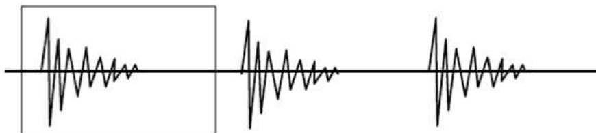
Figura 2.3.3.12 Ventana plana de un ensayo de resonancia. [12]
