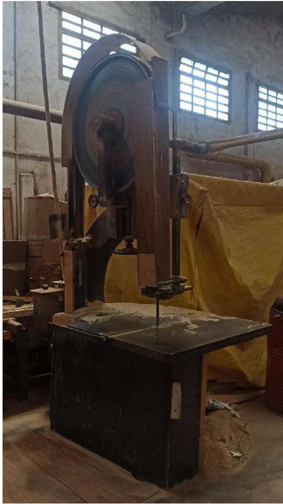
Figura 3.2.3.1 A1S/1: Sierra sin fin de 5,5kW de potencia.
