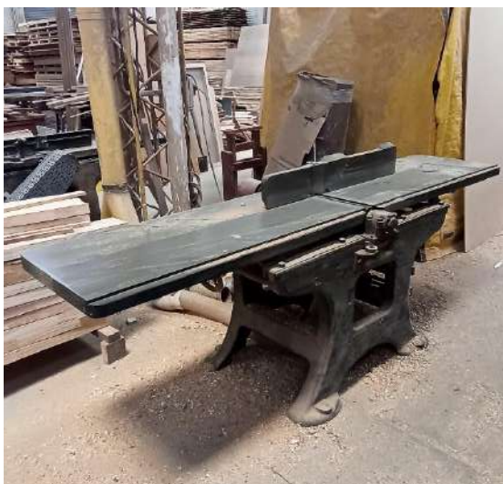
Figura 3.2.3.4 A1G/2: Garlopa de 4kW de potencia.
