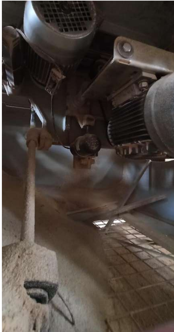
Figura 3.3.2.1 Escuadradora con partes móviles cubiertas de aserrín.
