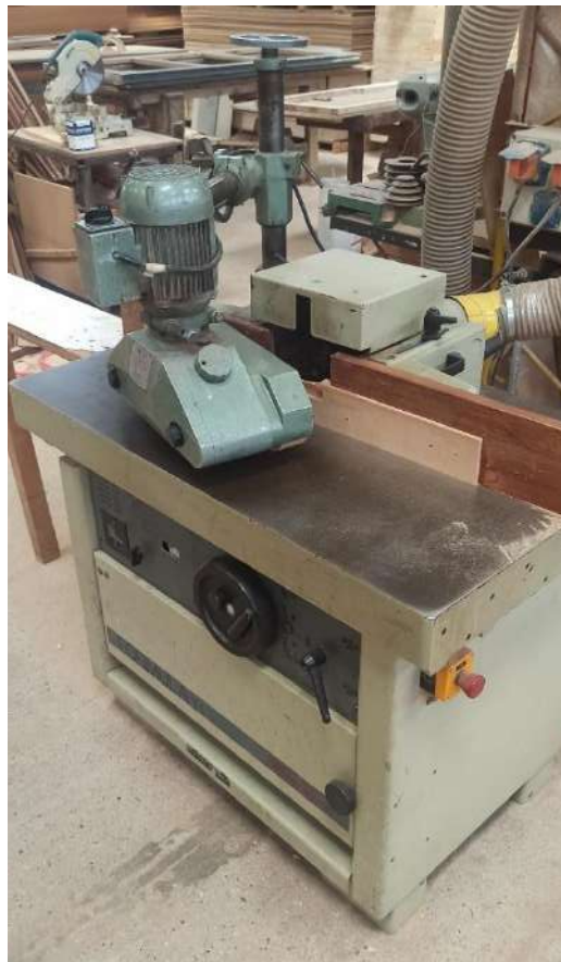
Figura 3.2.3.12 B1T/2: Tupí de 3,5kW de potencia marca Fórmula T1 MiniMax.
