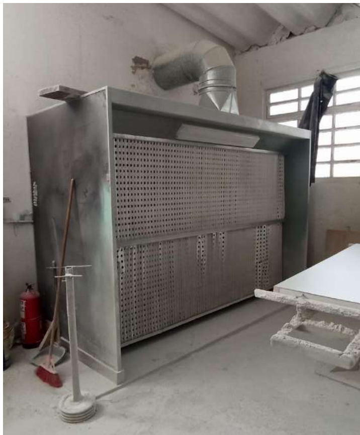
Figura 3.2.3.27 C3P: Cabina de pintura.
