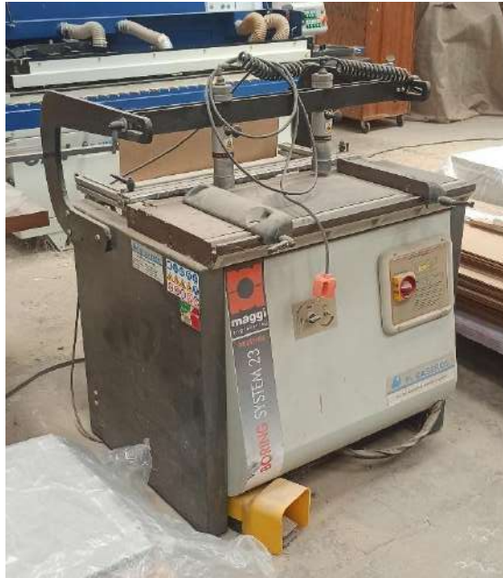
Figura 3.2.3.24 C2A: Agujereadora múltiple SYSTEM 23 de 1,5kW de potencia marca Maggi.
