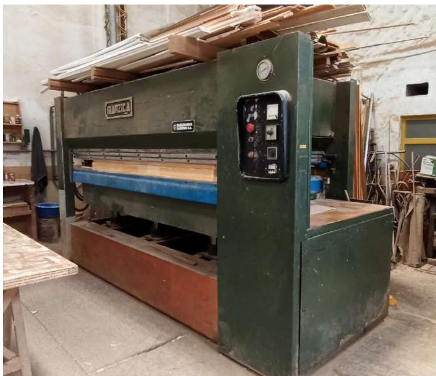
Figura 3.2.3.20 Prensa hidráulica en caliente marca Marzica. Al 2023 la más grande de la ciudad de Mar del Plata.
