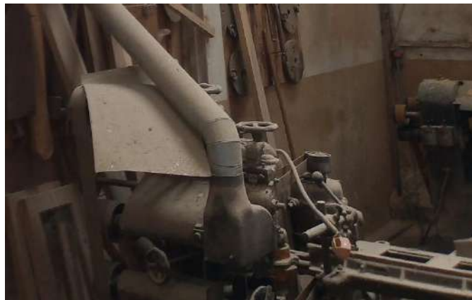
Figura 3.2.3.16 B1E/2: Escopladora de 3kW de potencia.
