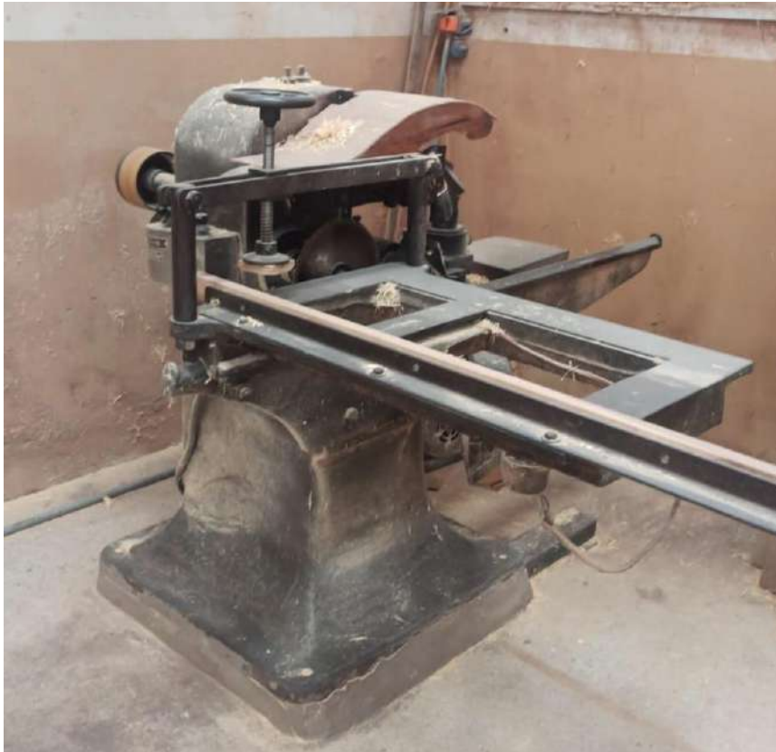
Figura 3.2.3.15 B1E/1: Escopladora de 3kW de potencia.
