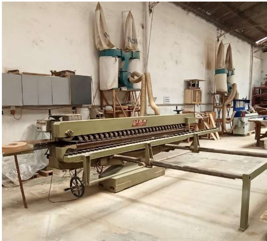
Figura 3.2.3.22 C1P: Pegadora de cantos de puertas placa de 1,5kW de potencia.
