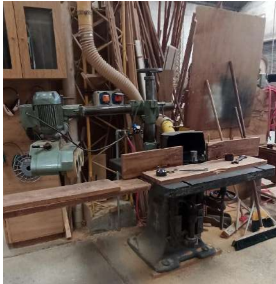
Figura 3.2.3.11 B1T/1: Tupí de 3,5kW de potencia marca Maschinen-Werke Gubisch.
