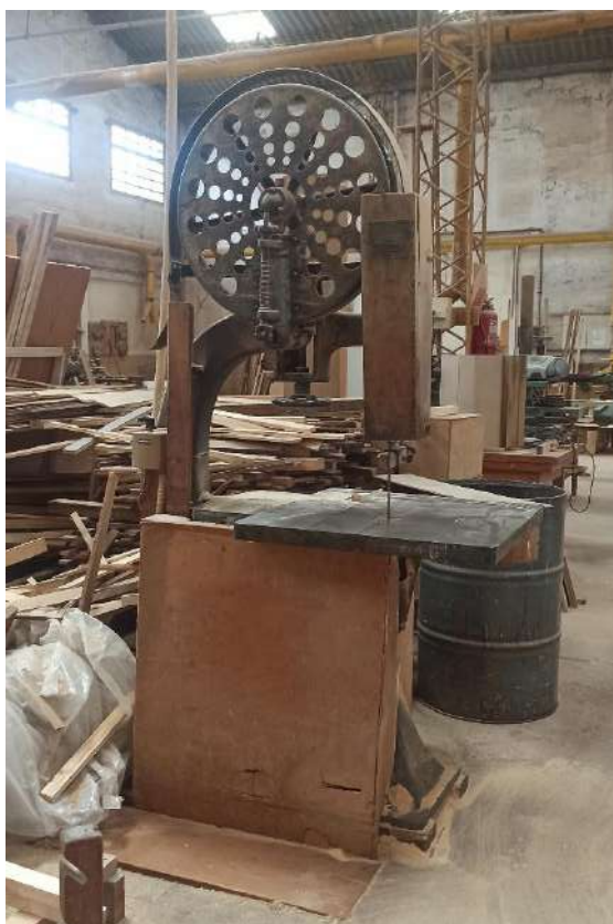
Figura 3.2.3.2 A1S/2: Sierra sin fin de 3kW de potencia marca Maschinenbau Scholz.
