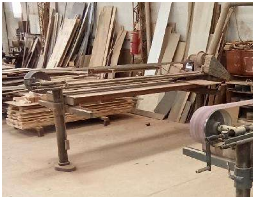
Figura 3.2.3.19 B2B/2: Lijadora de banda de 4kW de potencia.
