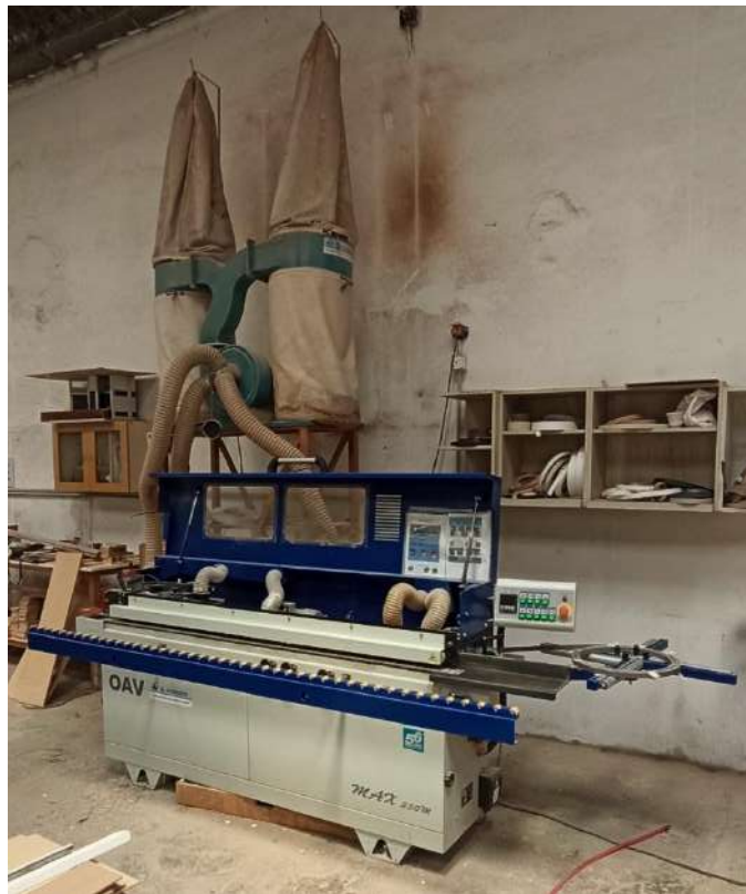
Figura 3.2.3.25 C2P: Pegadora de cantos OAV PEGASUS MAX 340M de 1kW de potencia.
