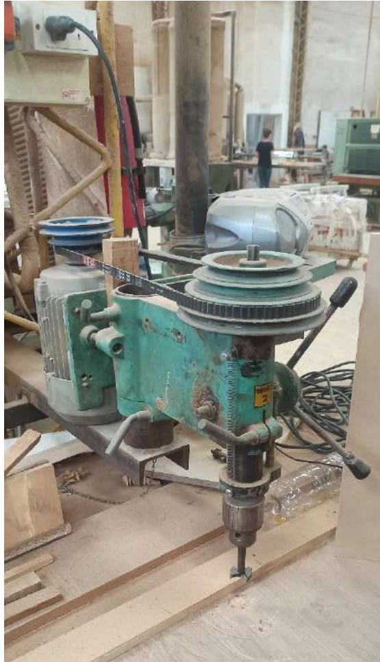
Figura 3.2.3.14 B1TB: Taladro de banco de 1,5kW de potencia.
