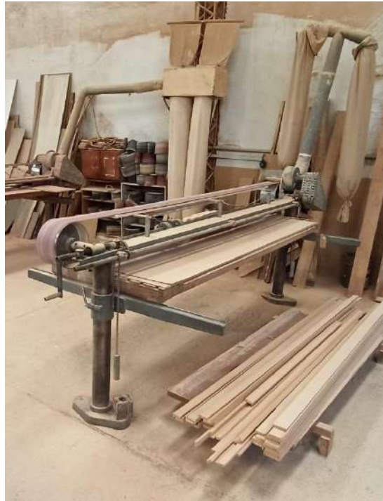
Figura 3.2.3.18 B2B/1: Lijadora de banda de 4kW de potencia.
