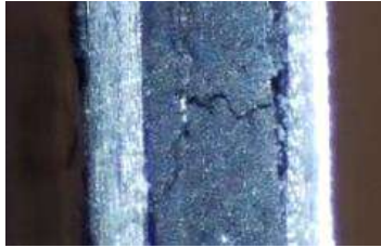
Figura 4.13. Microfisura detectada en ensayo de tracción de CFRP de matriz EAnAc 2 .
