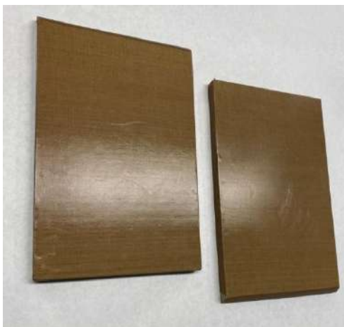
Figura 2.2. Placas metálicas cubiertas de una tela autoadhesiva de Teflón.
