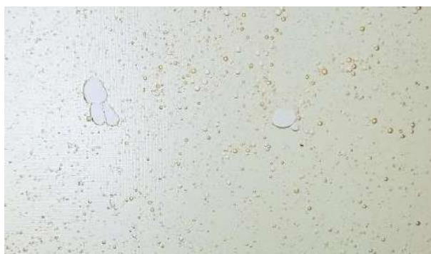
Figura 3.2. Placa defectuosa de matriz EAnAm.
