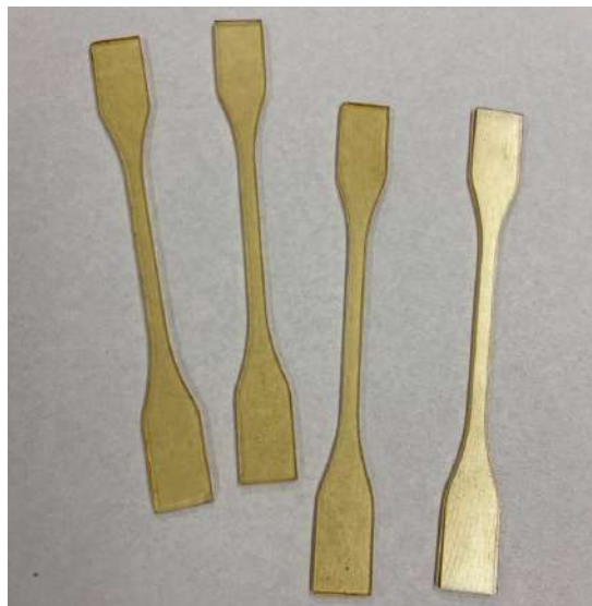
Figura 2.5. Probetas de matriz para ensayo de tracción uniaxial.
