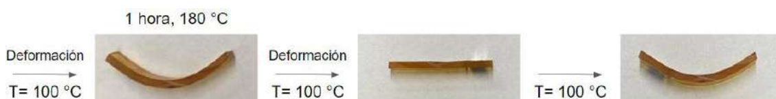
Figura 3.3. Imágenes del ensayo cualitativo de relajación de tensiones para E+AnGly. Se observa que el material retiene la nueva forma curvada en buena medida.
