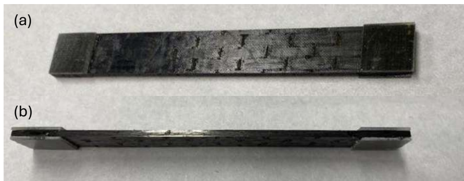
Figura 2.7. Probetas de material compuesto epoxi – fibra de carbono para ensayo de tracción uniaxial. (a) Frente. (b) Perfil.
