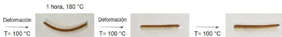
Figura 3.4. Imágenes del ensayo cualitativo de relajación de tensiones para EAnGly2. Se observa que el material no retiene la nueva forma curvada y mantiene su forma plana original, anterior al inicio del ensayo.
