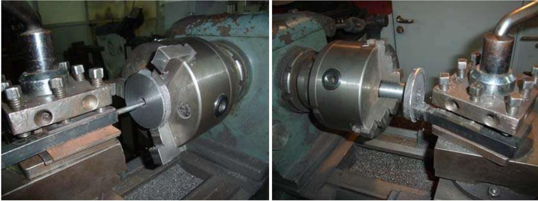
Figura 4.4. Etapas de mecanizado de los discos
