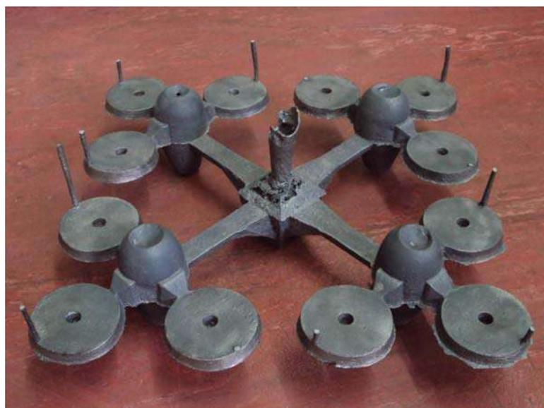
Figura 5.20. Pieza colada utilizando el molde diseñado
