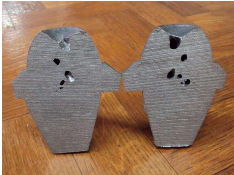
Figura 5.21. Corte longitudinal de una de las mazarotas del molde
