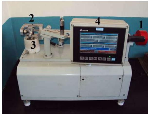
Figura 8.2. Tribómetro pin-on-disk
