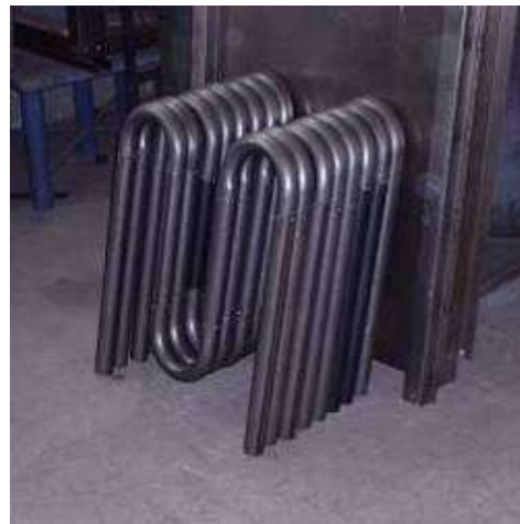
FIGURA 5-3 Tubos curvados para armado del intercambiador
