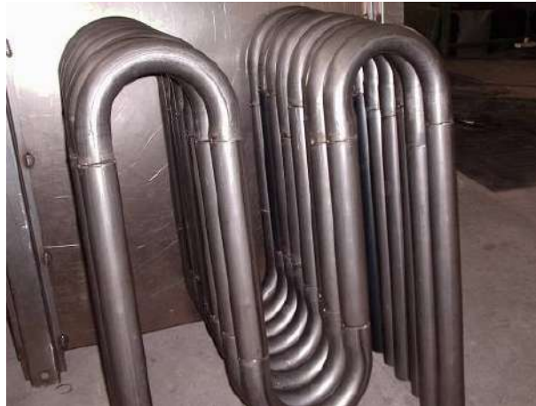
FIGURA 5-2 Tubos curvados para armado del intercambiador
