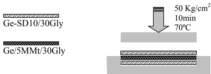
Figura VI.2. Esquema del procesamiento de moldeo por compresión para la obtención del multicapa
