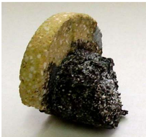
Figura 22. Aspecto de la reparación realizada en el laboratorio con el polvo comercial A (ensayo 5).
