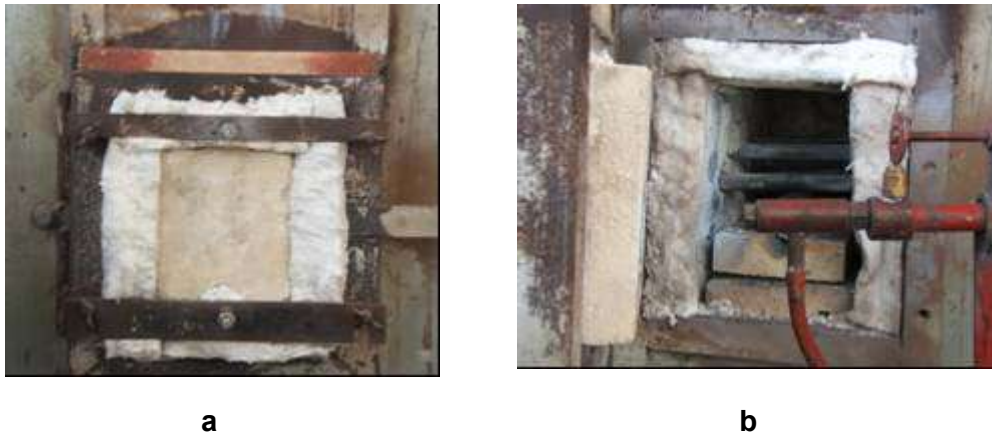
Figura 16. Disposición 1: puerta del horno cerrada con el sustrato refractario en su parte central: calentamiento y estabilización (a); puerta del horno abierta: proyección de la mezcla sobre el sustrato (b).
