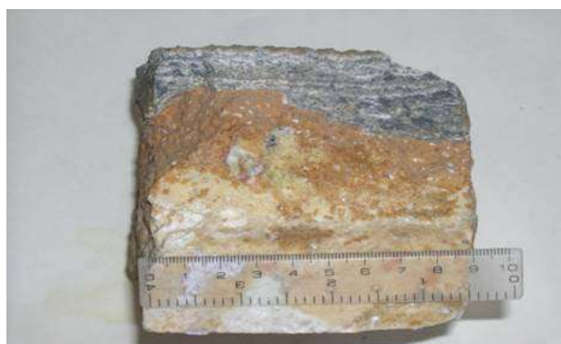
Figura 11. Ladrillo de sílice post-mortem reparado por soldadura cerámica.
