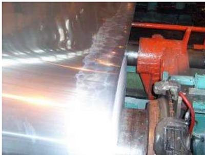
**Oxido decoloración:** una decoloración o no uniforme apariencia debida a la oxidación del metal durante el tratamiento térmico.
