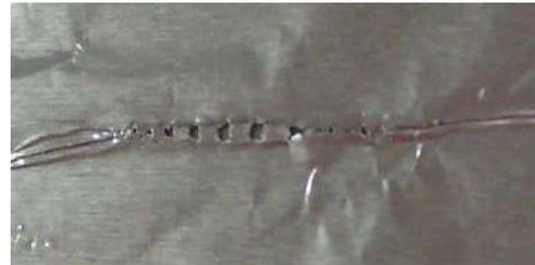
**Causa:** Generalmente se deben a espiras adyacentes flojas debido al uso de tracciones de enrollado y desenrollado inadecuadas. También pueden deberse a otras situaciones que generen resbalamiento entre espiras, como el desenrollado de una bobina desplazada en la cual se producen fricciones en el sentido transversal (oscilación) a la dirección de laminado.
