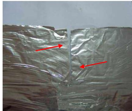
**Aspecto Exterior:** Irregularidad localizada o generalizada desde el inicio del bobinado que progresivamente van disminuyendo hasta su desaparición.
