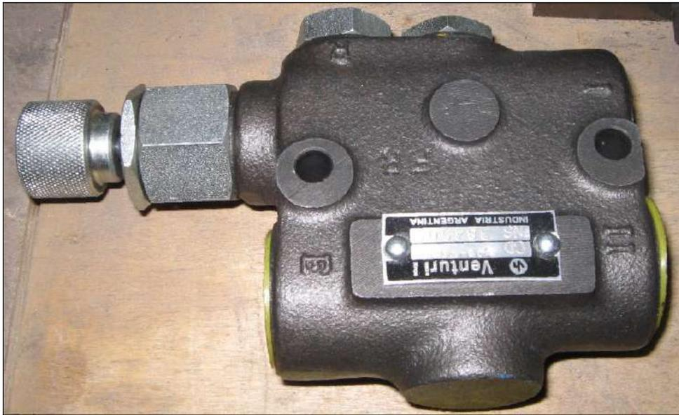
Figura N° 30: Válvula reguladora de Caudal adquirida.
