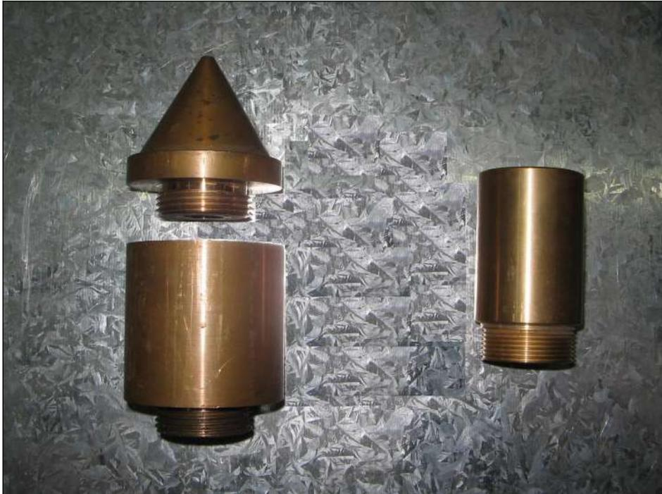
Figura N° 48: Válvulas construidas y pico inyector.
