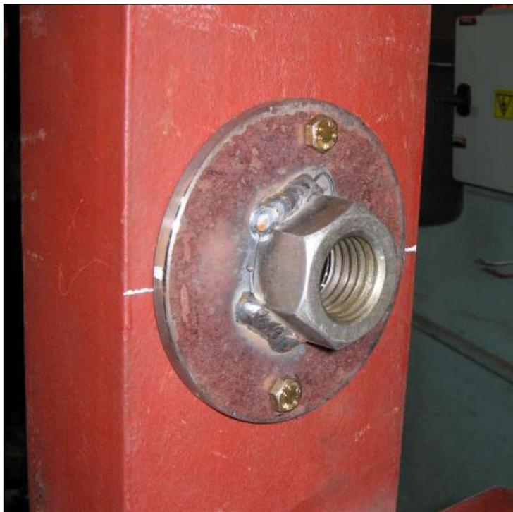
Figura N° 53: Tuerca fija a la estructura.
