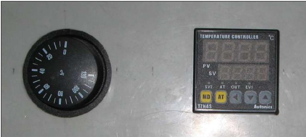
Figura N° 51: Termostato y controlador PID.
