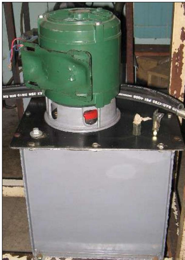
Figura N° 28: Conjunto bomba-motor-depósito.
