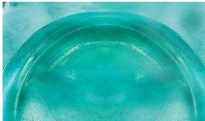
Figura 7.3. Plato de PET reciclado obtenido por termoformado.
