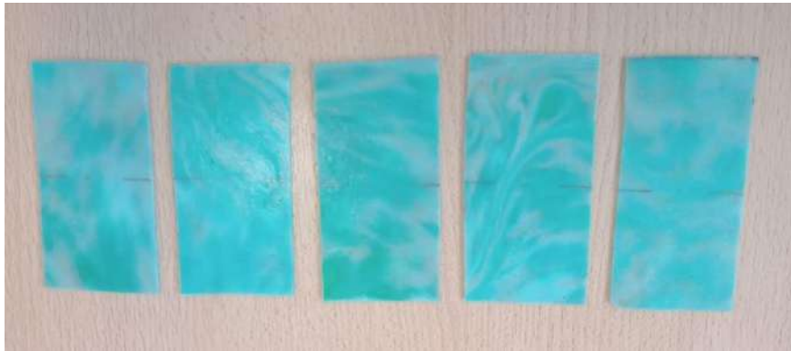
Figura 2.14. Probetas para comportamiento a la fractura de rPET.
