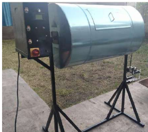
Figura 2.5. Horno de secado IR
