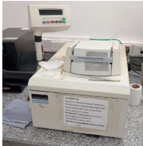
Figura 2.9. Equipo de DSC utilizado
