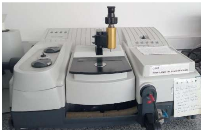
Figura 2.10. Equipo de FTIR-ATR utilizado
