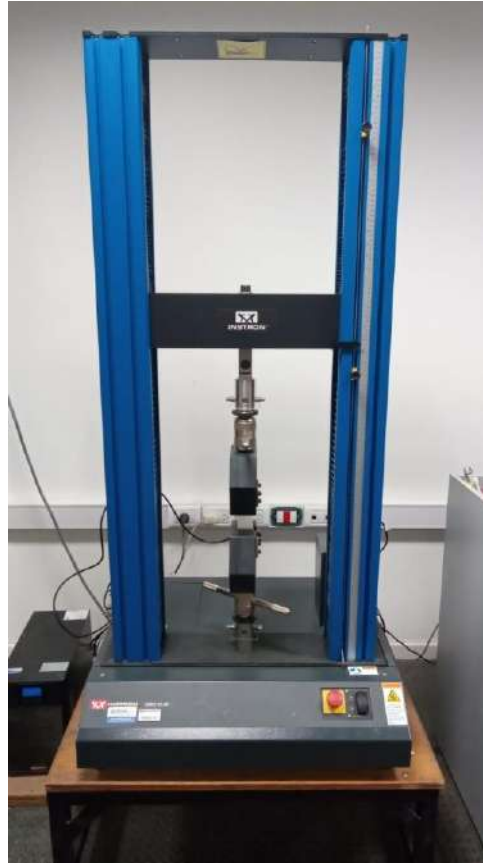
Figura 2.15. Dinamómetro INSTRON EMIC Modelo 23-50.
