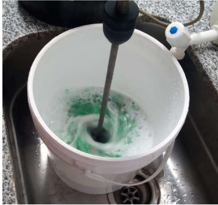
Figura 2.2. Proceso de lavado con agitador mecánico
