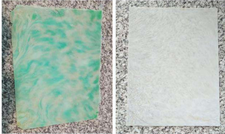
Figura 2.7.a) Placa de PET reciclado y b) Placa de PET virgen.
