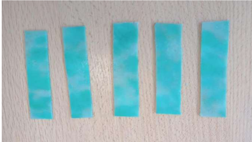
Figura 2.13. Probetas para Flexión en 3 puntos de rPET.
