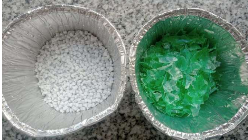
Figura 6.1. Pellets de PET virgen y scrap de PET reciclado.
