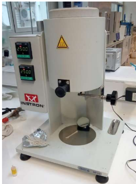
Figura 2.11. Equipo de Melt Flow Index utilizado
