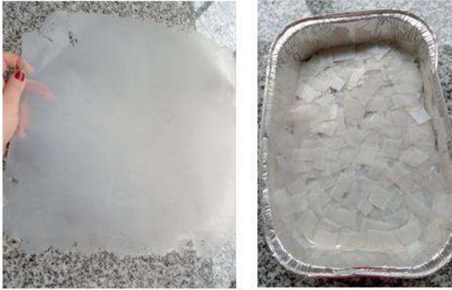
Figura 6.2. Flat vPET, antes y después de ser cortado para facilitar su manipulación.
