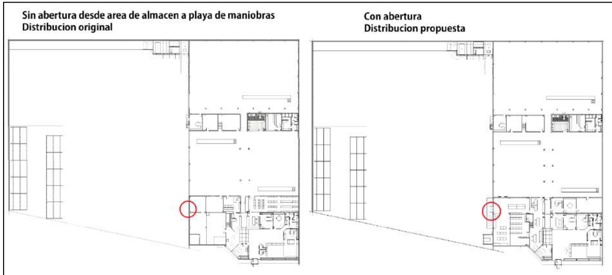
Ilustración 11 Abertura desde almacén hacia playa de estacionamiento
