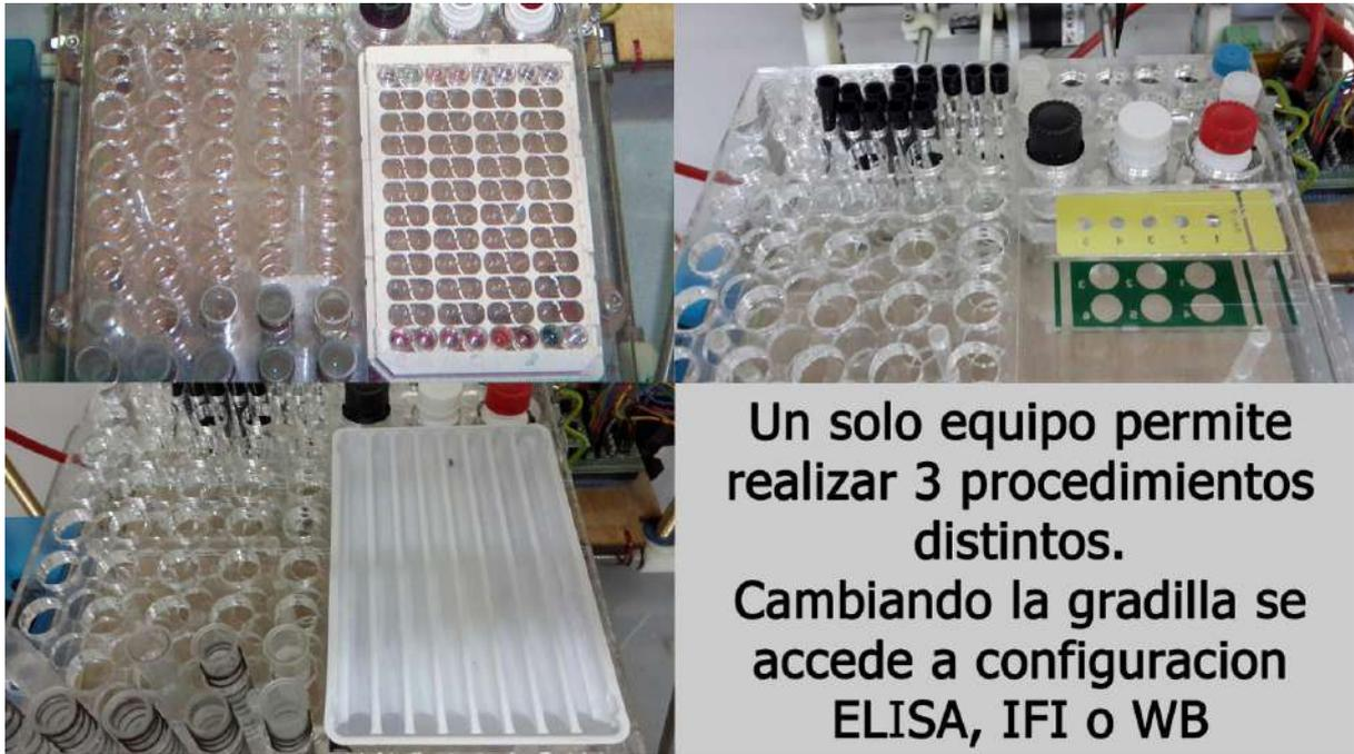
Figura 35: La extensión del proyecto adapta la gradilla para realizar 3 procedimientos.
