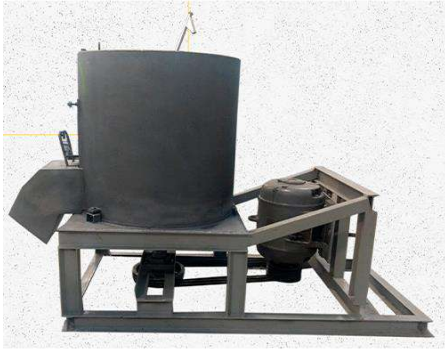
Figura 28: Aglutinadora para plástico.
