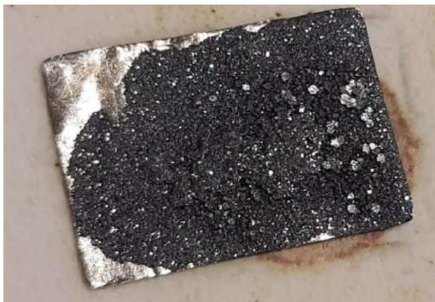
**Figura 5.1.** Fotografía de la muestra de composición 60BZCT-40NZF sinterizada a 1400 °C sobre una placa de platino.
