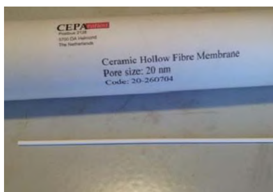
Figura 3.3. Membrana de fibra hueca cerámica con tamaño de poro nominal de 20 nm.
