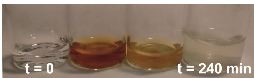
Figura 4.16. Evolución de color en un ensayo típico de CWHPPO de fenol (5 g/L) con el catalizador 2FeAl900 ( T = 70\text{ }^{\circ}\text{C} , [\text{Fenol}]_0 = 0,048\text{ M} , [\text{Cat}] = 1,8\text{ g/L} , ([\text{H}_2\text{O}_2]:[\text{Fenol}]) = 11,2 ).
