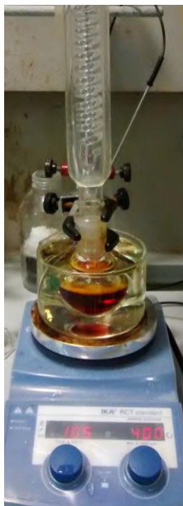
Figura 3.5. Síntesis de NPs de hematita a partir del método de microemulsión.
