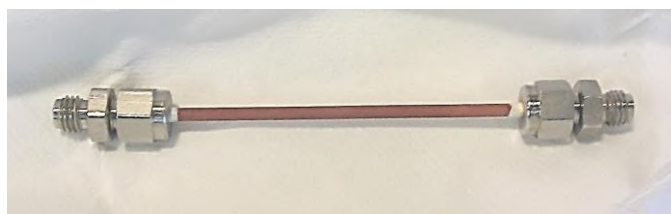
Figura 3.11. Adaptación de las fibras huecas para ser acopladas al sistema de tuberías.
