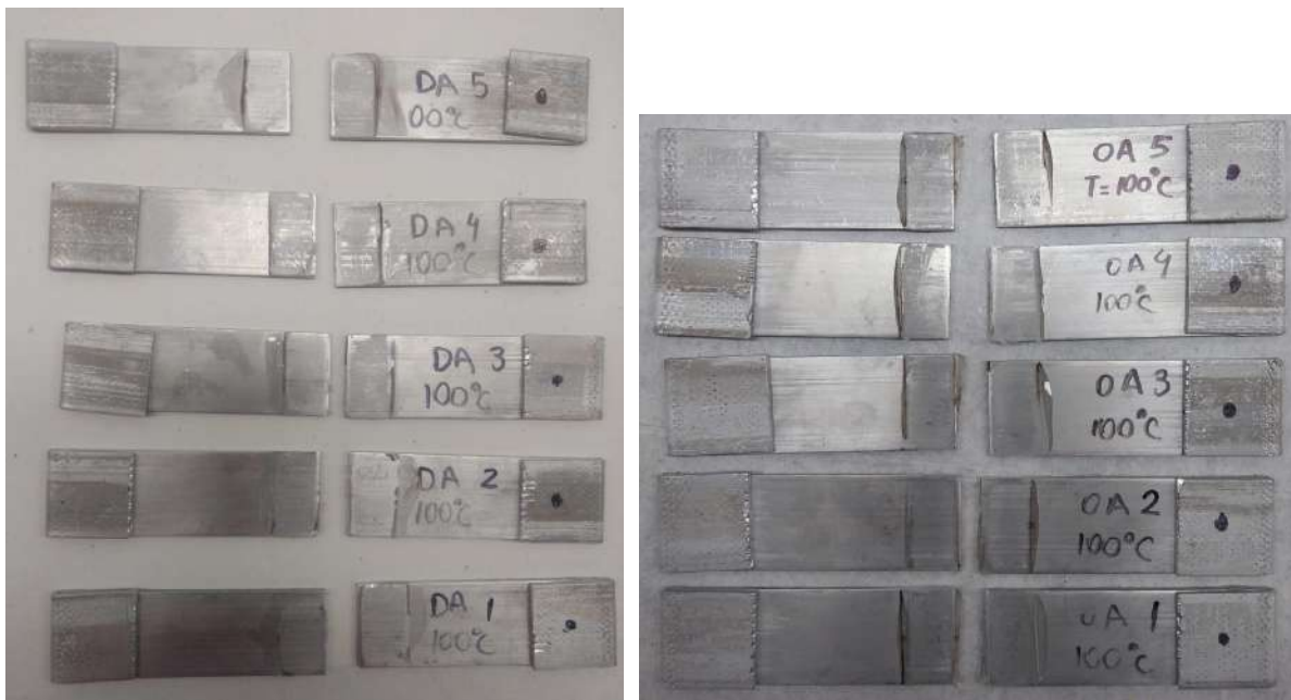
Figura 18. Probetas despegadas del ADH-1 (izquierda) y del ADH-2 (derecha) luego del ensayo
