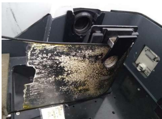
Figura 36. Placa rectangular durante el ensayo de FT-NIR del ADH-1 (modo 2)
