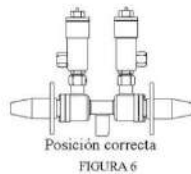
Figura XI. 7: Válvula de seguridad dual
