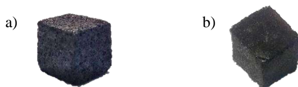
Figura 4.6. Cuerpos híbridos porosos típicos obtenidos por calcinación de las muestras preparadas empleando sacarosa (a) y parafina (b).
