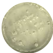
Figura 2.2. Cuerpo consolidado por condensación de grupos silanoles sin amina.
