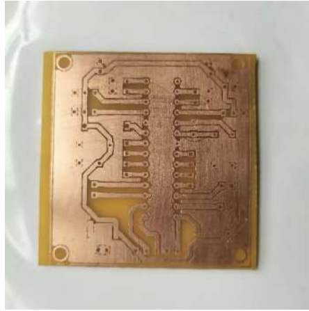
Figura 3-9. Circuito impreso de la placa principal
