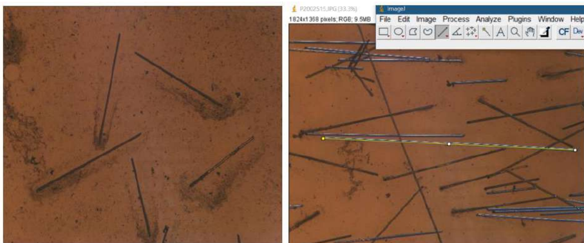
Figura 11. Micrografías típicas utilizadas para las medidas de longitud.
