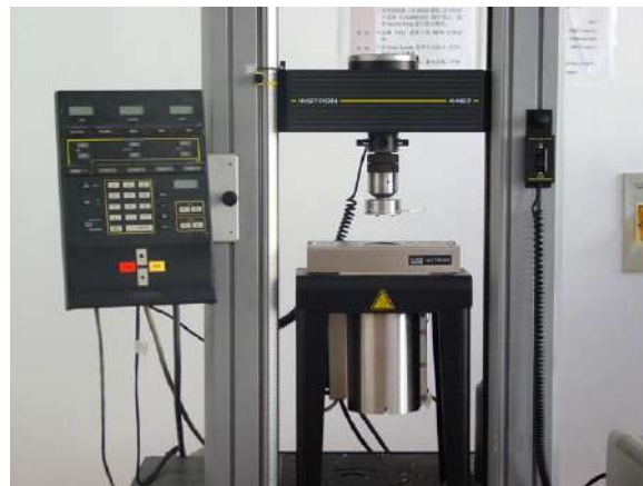
Figura 7.8: Máquina de ensayos universal Instron 4467.
