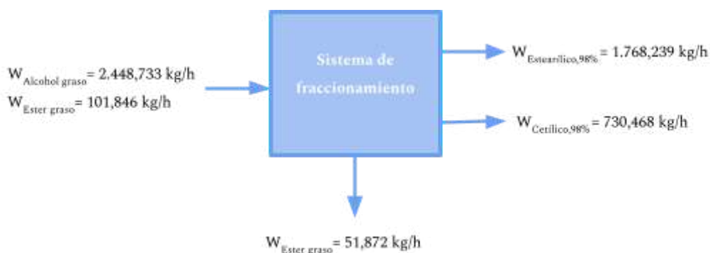
Figura 2.14. Diagrama del sistema de fraccionamiento.
