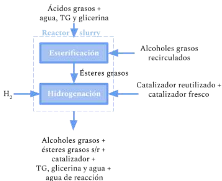
Figura 2.1. Diagrama en bloques de reacción de hidrogenación y esterificación.
