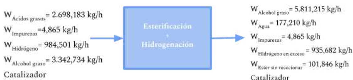
Figura 2.9. Diagrama de corrientes másicas de entrada y salida del sistema de reacción.
