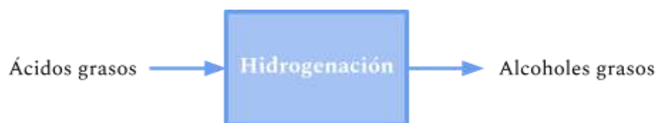
Figura 1.8. Diagrama en bloques simplificado de la hidrogenación de ácidos grasos.
