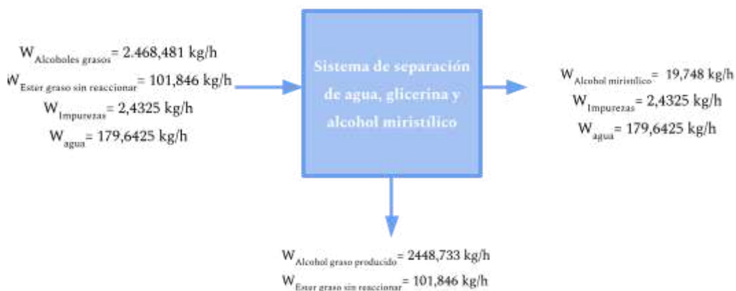
Figura 2.13. Diagrama del sistema de separación de agua, glicerina y alcohol miristílico.
