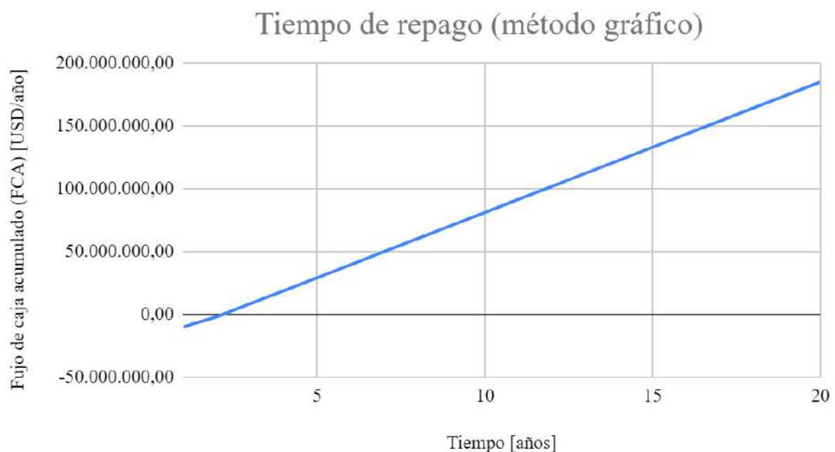
Figura 6.7. Método gráfico para el cálculo del tiempo de repago.
