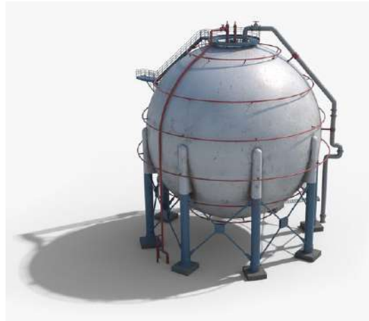
Figura 5.24. Tanque esférico de almacenamiento de gases a alta presión.
