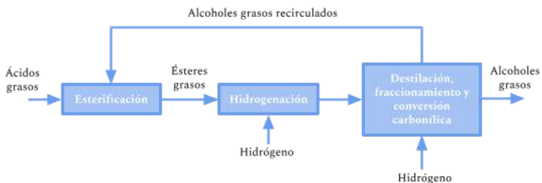
Figura 1.12. Diagrama en bloques de la hidrogenación de ésteres grasos.
