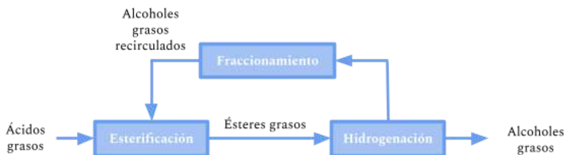
Figura 1.11. Diagrama en bloques simplificado de la hidrogenación de ésteres grasos.
