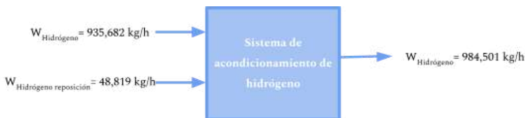
Figura 2.11. Diagrama de corrientes másicas de entrada y salida del sistema de acondicionamiento de hidrógeno.
