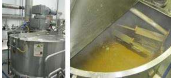
Figura 8: Marmita de cocimiento vista exterior (izquierda) y vista interior (derecha).
