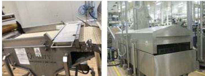
Figura 14: Cinta de entrada al freidor (izquierda) y freidor (derecha).
