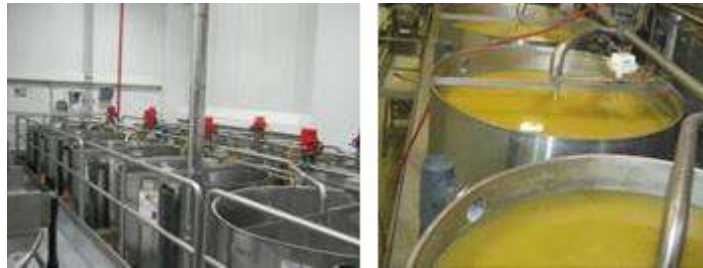
Figura 9: Tanques de reposo
