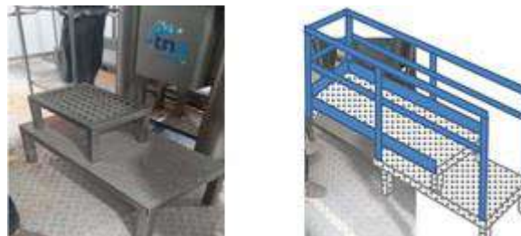
Figura 54: Plataforma para limpieza de acumulador (izquierda) y propuesta de modificación en plataforma para limpieza de acumulador (derecha). Fuente: Información relevada de la compañía.
