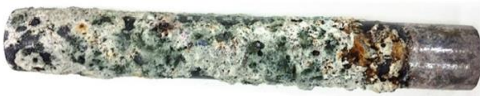
Figura 11. Óxido de color verde producto de la corrosión.
