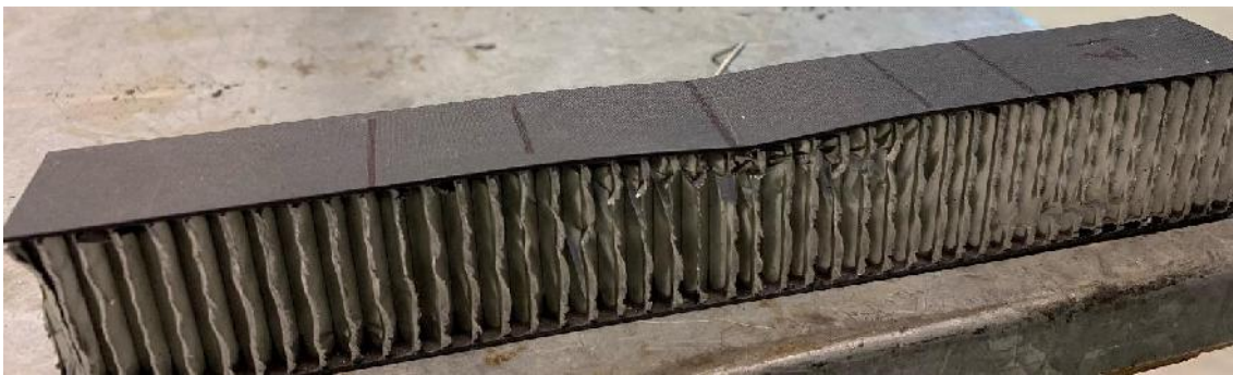
Ilustración 2-22 Probeta 17 impactada a 3,65148 J.
