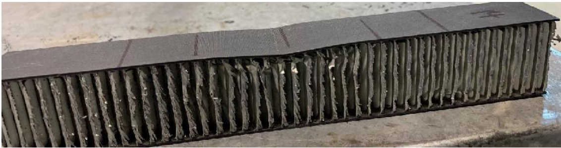
Ilustración 2-21 Probeta 14 impactada a 3,0164 J.
