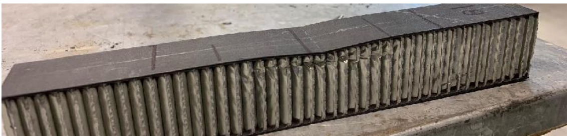
Ilustración 2-23 Probeta 18 impactada a 4,28652 J.
