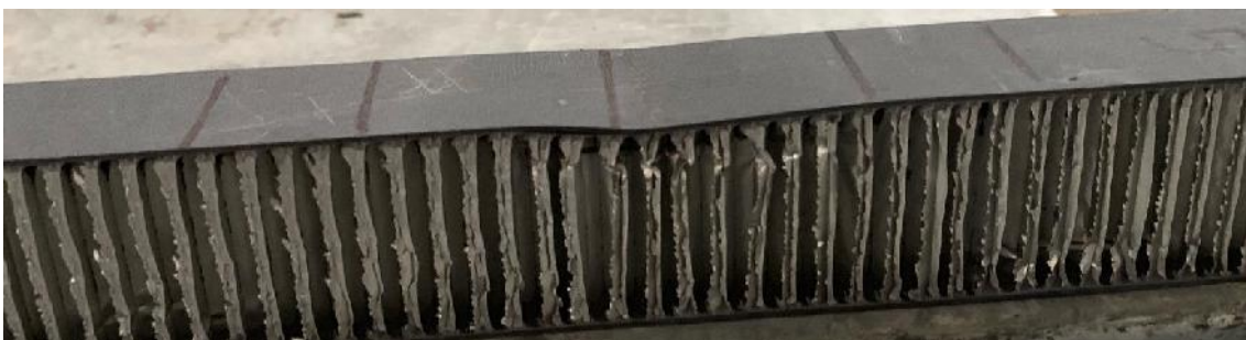
Ilustración 2-19 Probeta 5 impactada a 1,74636 J.
