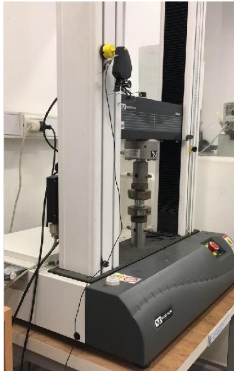
Ilustración 2-10 Máquina de ensayos INSTRON 3369.
