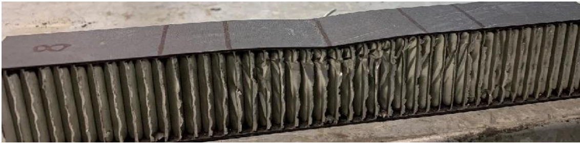
Ilustración 2-20 Probeta 8 impactada a 2,3814 J.
