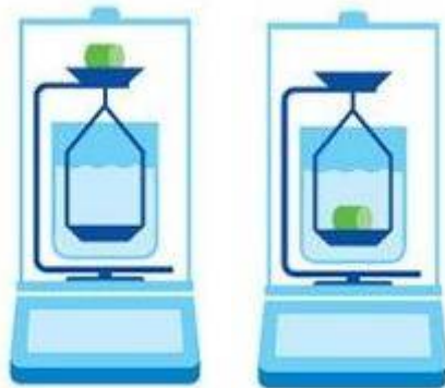
Ilustración 2-5. Masa de la probeta en aire (izquierda). Masa de la probeta sumergida (derecha).
