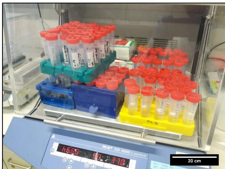
Figura 4-9. Muestras colocadas dentro de la incubadora a 37°C.
