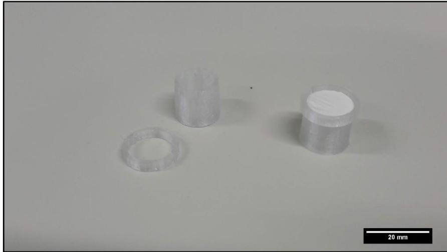
Figura 4-8. Portador y anillo (derecha) y portador con la membrana colocada (izquierda).
