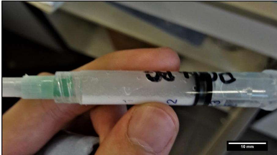
Figura 5-1. Partículas decantadas en una solución de PCL-BG30 luego de 24 horas.
