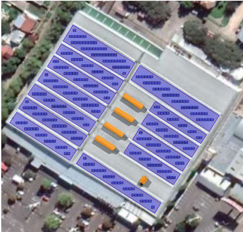
Figura 3.40 - Vista superior del arreglo de paneles solares
