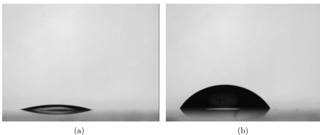
Figura A.1: a) Perfil de gota sobre portaobjetos, b) perfil de gota sobre recubrimiento de \text{SiO}_2 .
