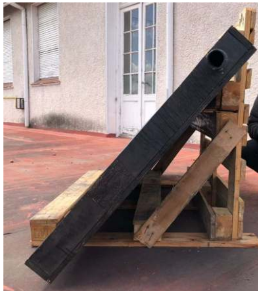
Figura 12: Captador ubicado a 45 grados en el soporte respecto del piso. Fuente: Elaboración propia.
