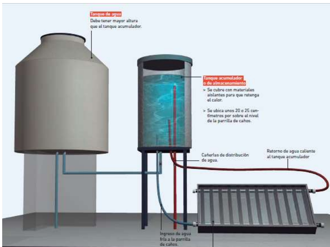
Figura 7. Instalación para la obtención de agua sanitaria por energía solar Fuente: "Termotanque solar de agua. Construcción de tecnologías apropiadas", INTA (2013)
