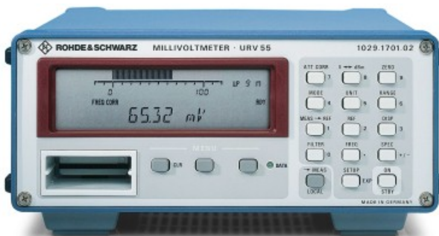
Figura 1.5: Milivoltímetro textitRF Rohde & Schwarz URV 55.
