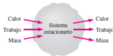
Figura 30. Esquema de velocidad de transferencia de energía en un sistema estacionario.
