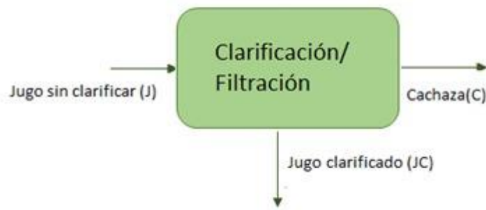
Figura 7.5: diagrama simplificado de la clarificación y filtración del jugo
