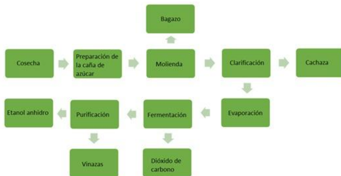
Figura 1.1: esquema del proceso de producción de bioetanol
