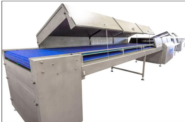
Figura 8.21. Túnel de enfriamiento AMCCT (AMC, 2019).
