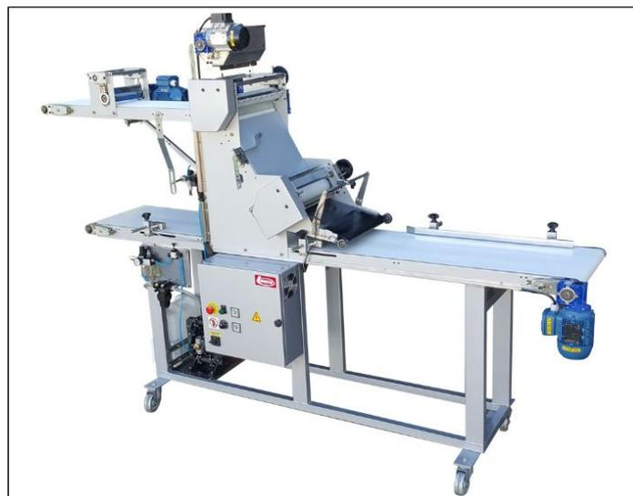
Figura 8.14. Laminadora de masa EP 01 (IMEPA, 2017).
