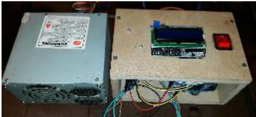
Figura 5.7: Sistema de control con su fuente de alimentación.
