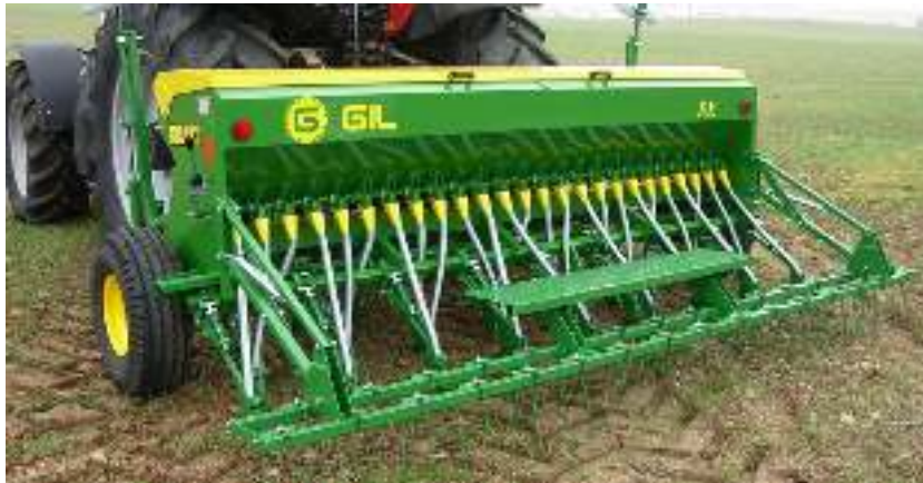
Figura 4.1: Máquina con una tolva ancha, similar a su ancho de labor.
