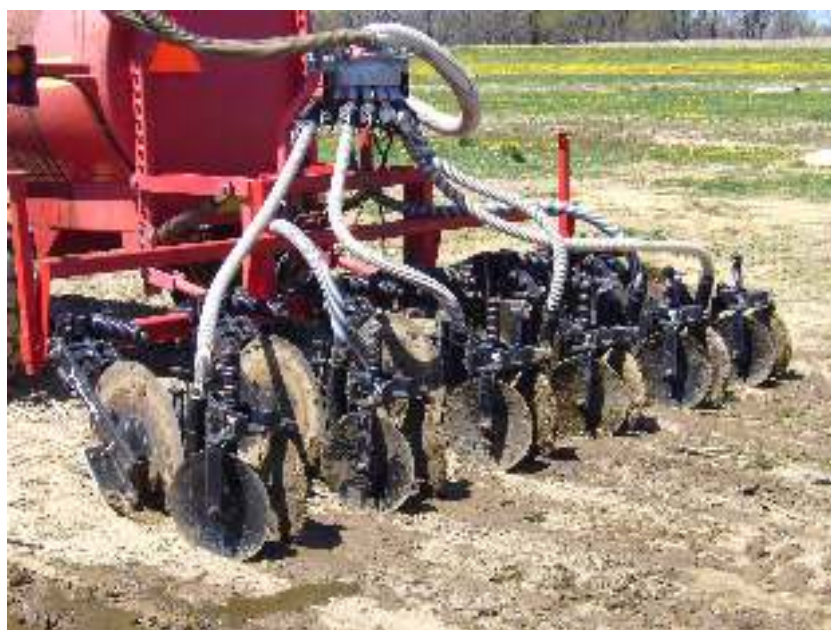
Figura A.7: Abonadora de estiércol líquido con discos.
