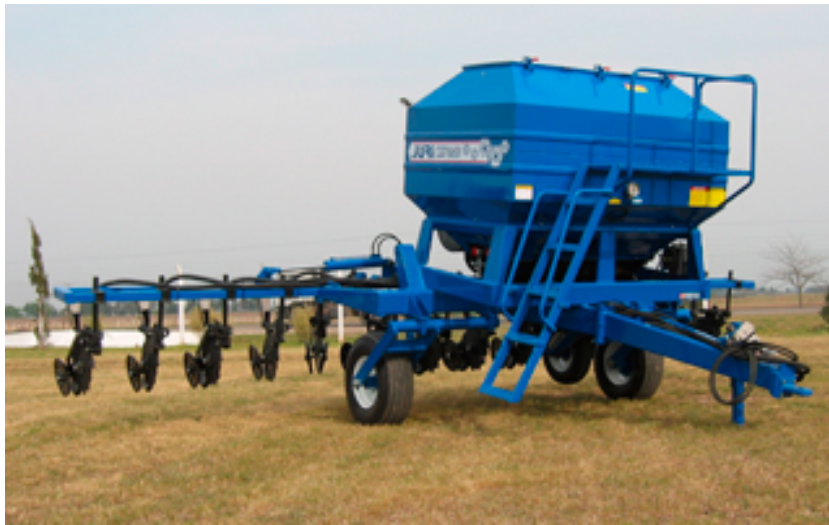
Figura 4.2: Máquina con una tolva angosta, en relación a su ancho de labor.
