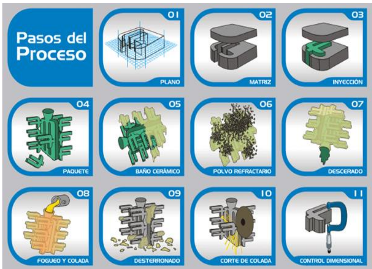
Figura 8: Etapas del proceso de producción por Microfusión Fuente: Empresa.
