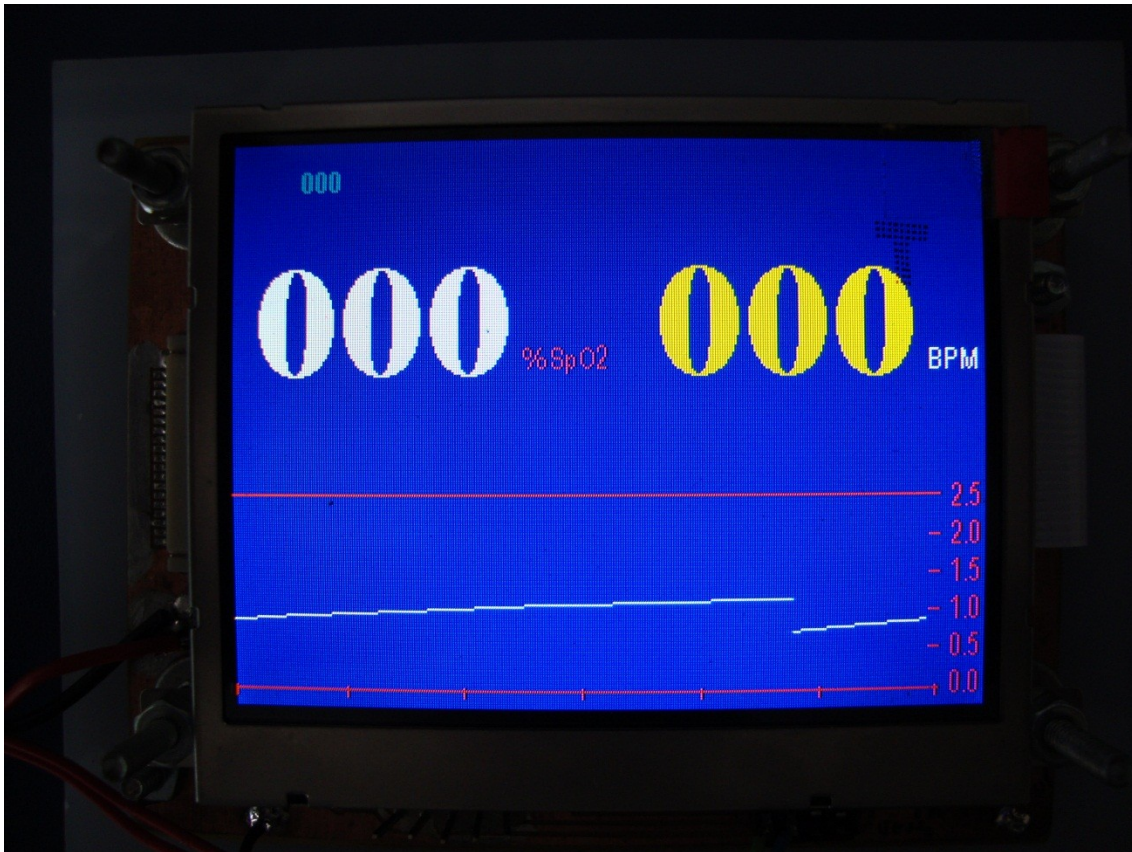
Figura5.5, Muestra del filtro IIR
