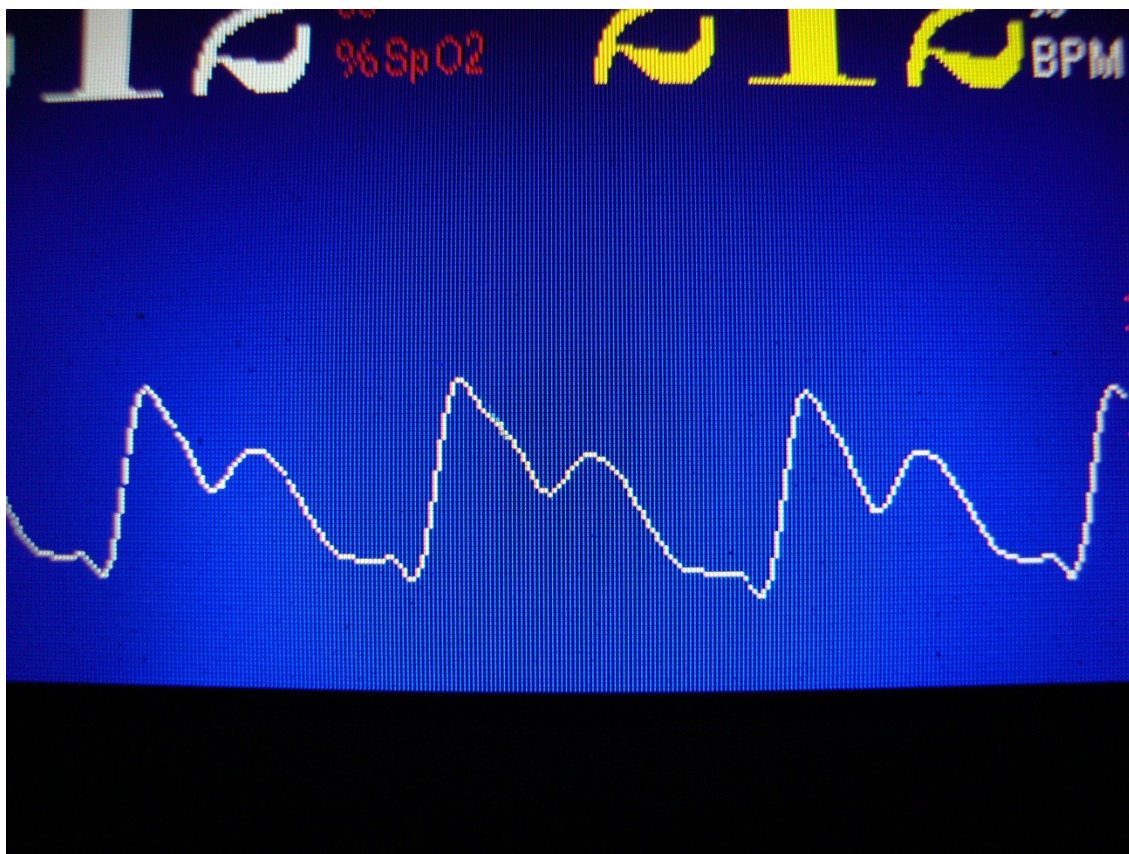
Figura 5.1, Curva pletismográfica en la pantalla del visor.
