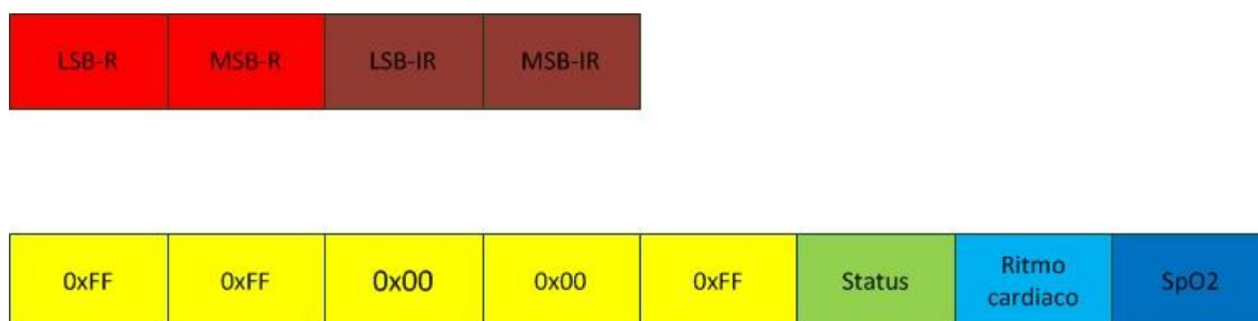
Figura 4.18, bytes de datos y encabezado enviados a la UART
