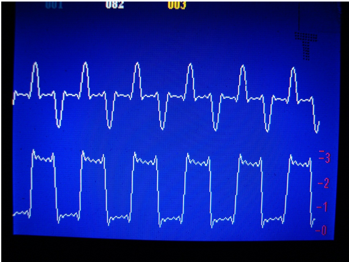
Figura 5.6, Onda cuadrada filtrada por el filtro diferencial
