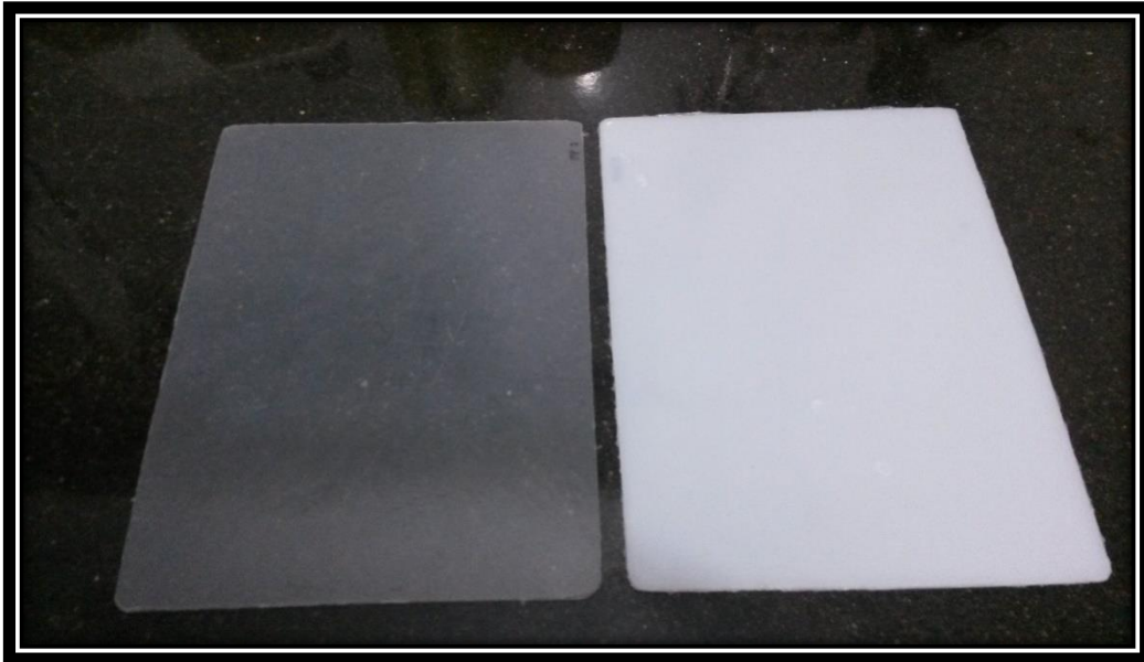
Figura 4.3: Placas de PP y de HDPE obtenidas mediante prensado.
