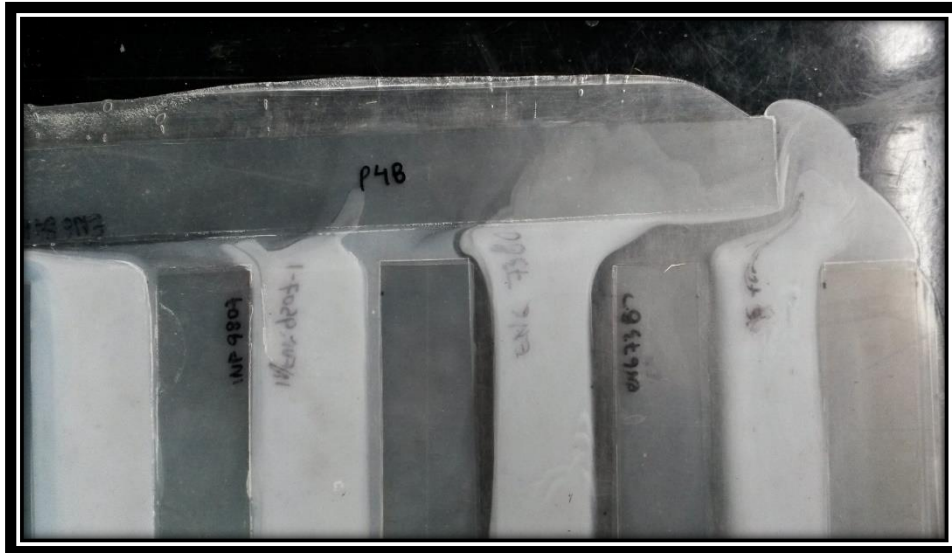
Figura 5.40: Muestras con defectos debido a la fusión del HDPE luego del tratamiento térmico
