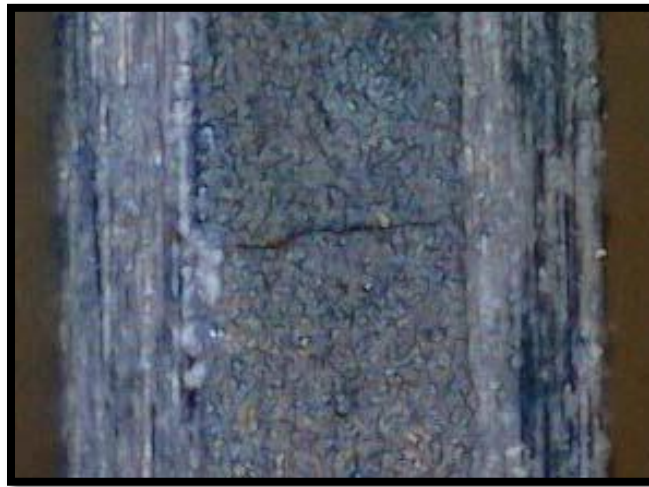
Figura 2.4 - Microfisura en laminado epoxi-fibra de carbono
