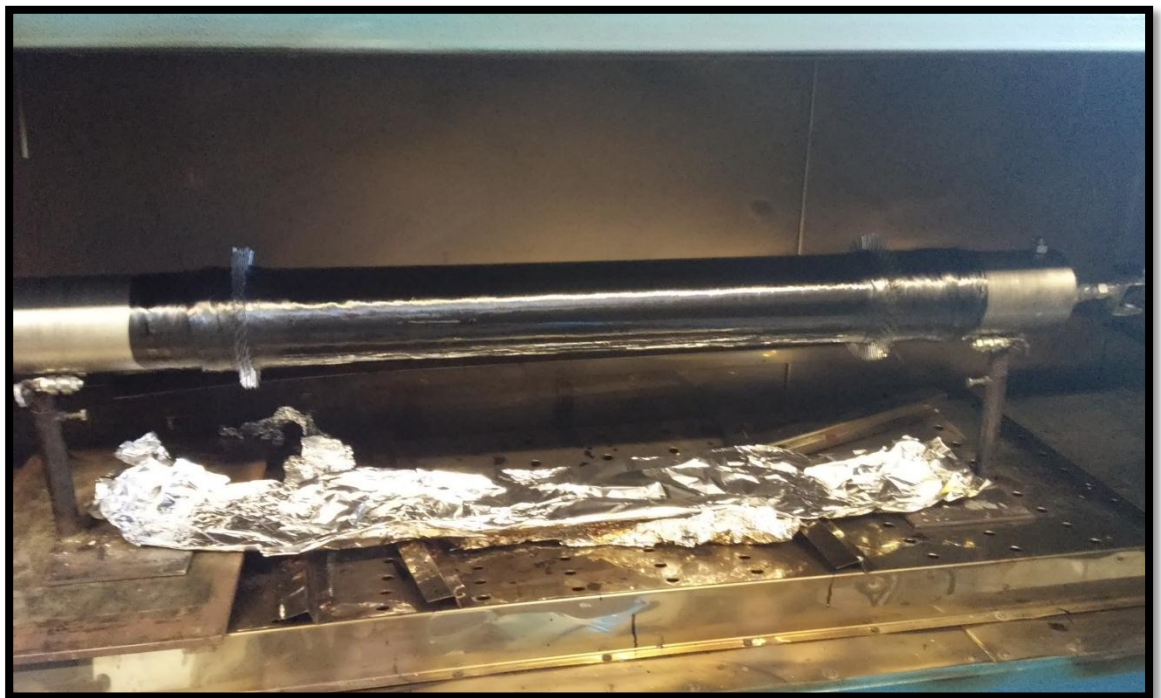
Figura 4.12 - Mandril con tubo terminado dentro del horno de curado
