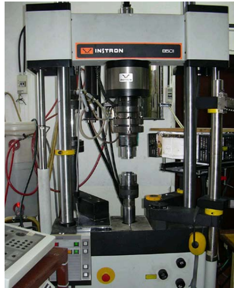
Figura 2.4. Máquina Universal de ensayos mecánicos INSTRON 8501.
