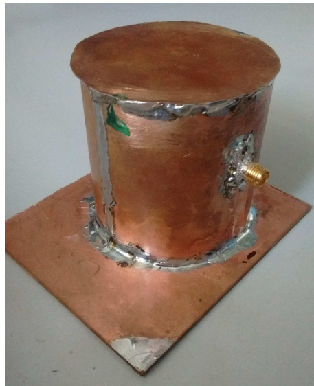
Figura 3.31: Cavidad resonante construida para caracterizar la constante dieléctrica de la resina "vidrio líquido" empleada en la construcción del sensor.
