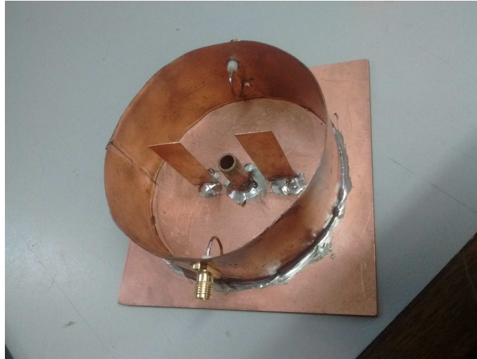
Figura 3.25: Primer prototipo de resonador, sin rellenar con resina, sin colocar la tapa superior.
