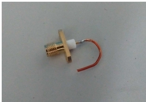
Figura 3.24: Prototipo construido de lazo de acoplamiento utilizando un conector de cable coaxial.
