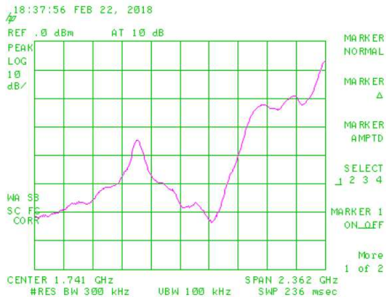
Figura 3.37: Transferencia S_{21} en un rango amplio de frecuencias, para una muestra de acetona ( \epsilon_r \approx 20,5 ). Se observa el máximo correspondiente a la resonancia de interés, y luego otros modos resonantes de mayor transferencia.
